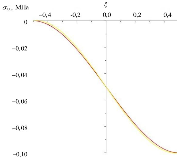
**Рис. 7.** Совместные графики зависимости напряжений межслойного сдвига
