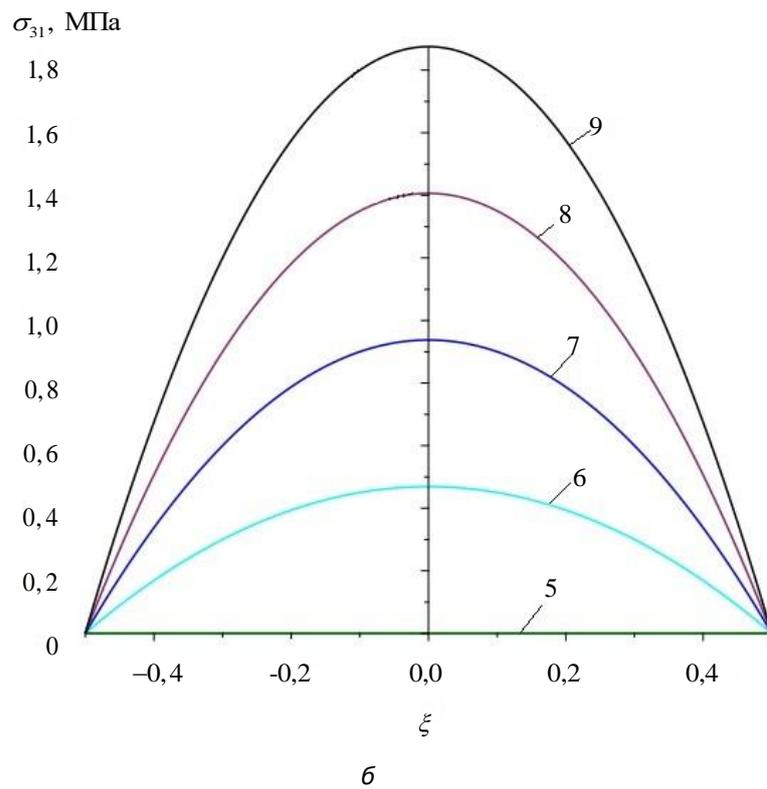
**Рис. 4.** Совместные графики зависимости напряжений межслойного сдвига  $\sigma_{31}$  от  $\xi$  при различных значениях  $x$  (1 —  $x=0$ , 2 —  $x=0,125$ , 3 —  $x=0,25$ , 4 —  $x=0,375$ , 5 —  $x=0,5$ , 6 —  $x=0,625$ , 7 —  $x=0,75$ , 8 —  $x=0,875$ , 9 —  $x=1$ )
