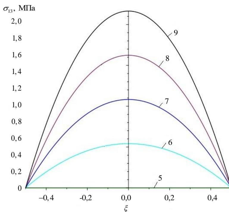
**Рис. 5.** Совместные графики зависимости напряжений межслойного сдвига  $\sigma_{13}$  от  $\xi$  при различных значениях  $x$  (1 —  $x=0$ , 2 —  $x=0,125$ , 3 —  $x=0,25$ , 4 —  $x=0,375$ , 5 —  $x=0,5$ , 6 —  $x=0,625$ , 7 —  $x=0,75$ ,
