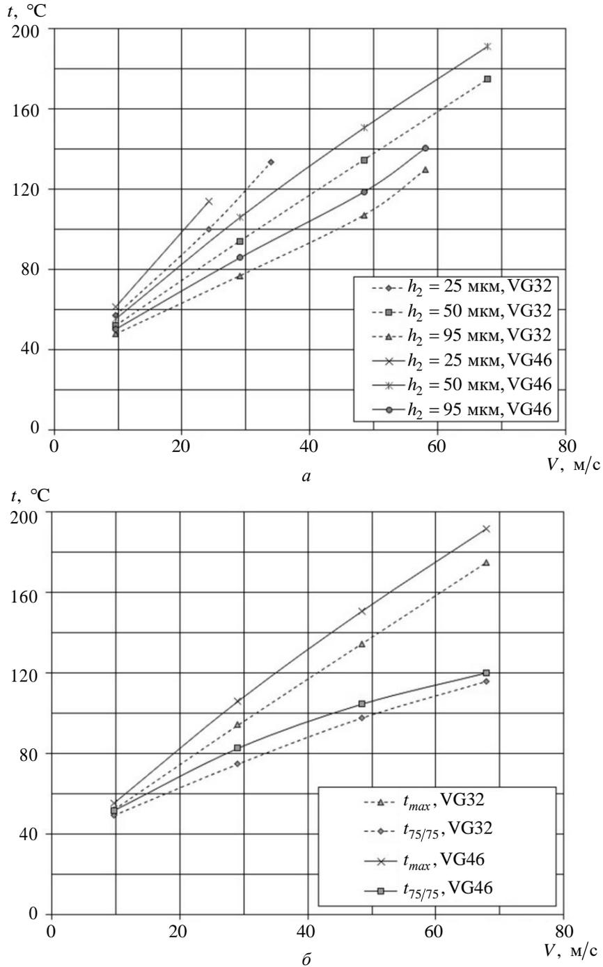
**Рис. 2.** Зависимость температур от средней окружной скорости вращения,  $t_0 = 40^\circ\text{C}$ :
