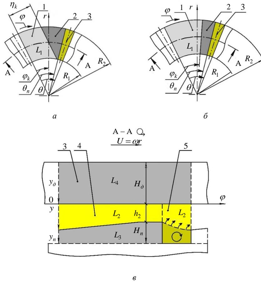
**Рис. 1.** Расчетная схема упорного подшипника скольжения:
