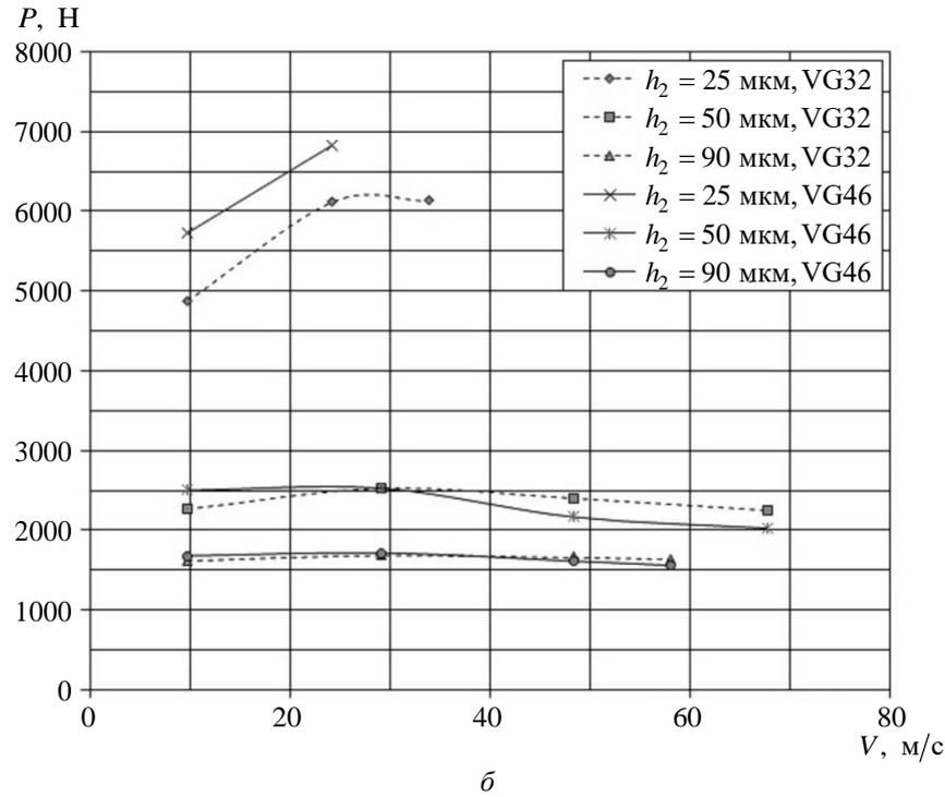
**Рис. 5.** Зависимость от средней окружной скорости вращения при разных зазорах  $h_2$  и классе вязкости,  $t_0 = 40^\circ\text{C}$ :
