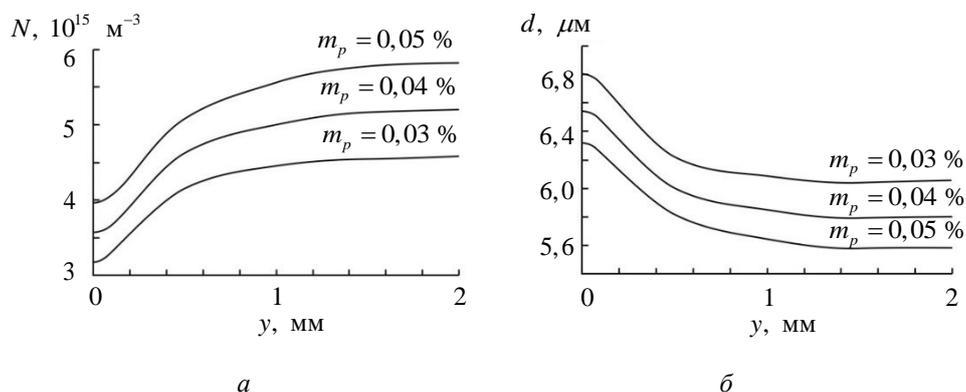
**Рис. 3.** Распределение числа кристаллов и характерного размера зерна в сварочном шве на верхней поверхности пластин для разных значений массовой концентрации  $m_p$  затравок в расплаве при  $\theta = 43^\circ$  :
