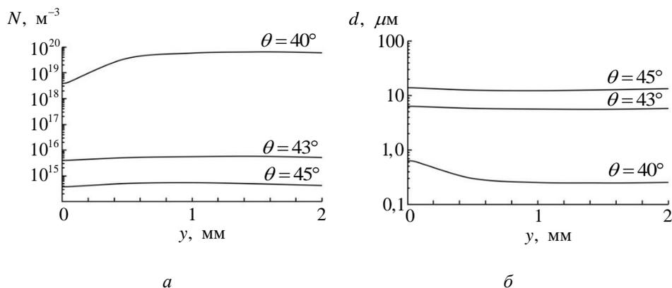
**Рис. 4.** Распределение числа кристаллов и характерного размера зерна в сварочном шве на верхней поверхности пластин ( $z = 0$ ) при разных значениях угла смачивания  $\theta$  и  $m_p = 0,05\%$  по массе:
