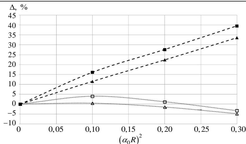
**Рис. 3.** Отклонение значений жёсткости на кручение, полученных с применением технической теории от результатов, полученных трёхмерными расчётами МКЭ; квадратные маркеры отмечают результаты для стержней с эллиптическим поперечным сечением, треугольные маркеры — результаты для стержней с прямоугольным поперечным сечением; сплошные маркеры и крупная штриховка соответствуют базовой технической теории [1, 2], пустые маркеры и пунктир соответствуют уточнённой технической теории
