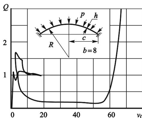
**Рис. 2.** Зависимость прогиба в центре  $v_0$  для пологой сферической оболочки от безразмерного параметра давления  $Q$  [4]
