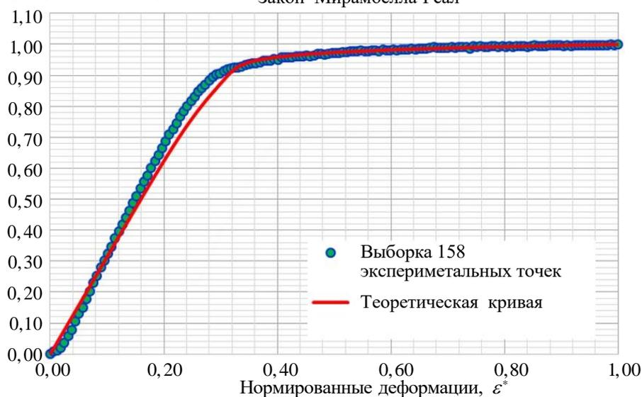
Рис. 2. Экспериментальная кривая титанового сплава ВТ6 и теоретическая кривая по модели Мирамбелл-Реал
