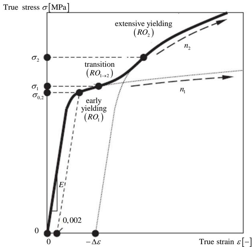
Рис. 5. Графическая иллюстрация модели UGent
