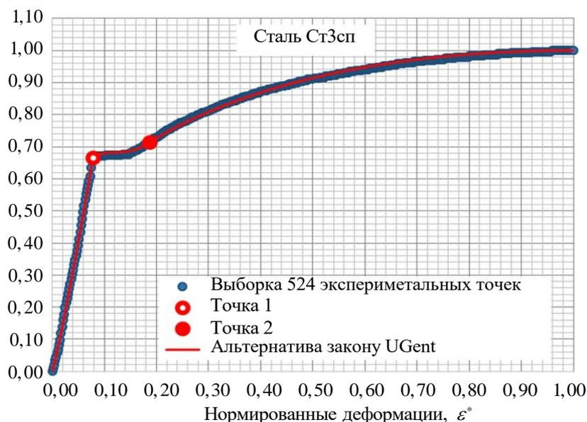
**Рис. 6.** Экспериментальная кривая стали СтЗсп и теоретическая кривая построенная по модели Белова-Головиной:
