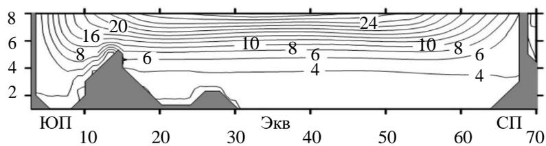
Рис. 5. Распределение температуры по глубине в Атлантическом океане
