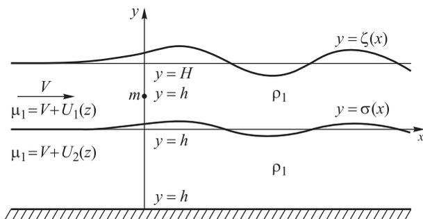
Рис. 1. Обтекание диполя, локализованного в верхнем слое
