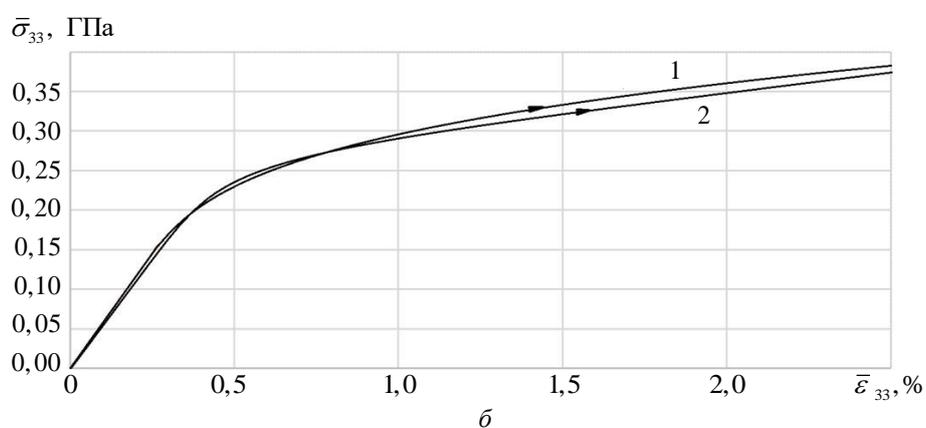
**Рис. 1.** Диаграммы деформирования  $\bar{\sigma}_{33} \sim \bar{\epsilon}_{33}$  композита при одноосном нагружении в поперечном направлении:
