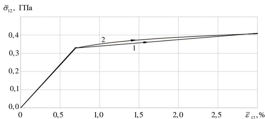
Рис. 3. Диаграммы деформирования  $\bar{\sigma}_{12} \sim \bar{\epsilon}_{12}$  композита при сдвиге в плоскости слоя:
