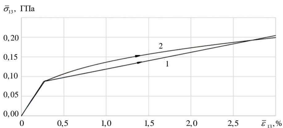
**Рис. 2.** Диаграммы деформирования  $\bar{\sigma}_{13} \sim \bar{\epsilon}_{13}$  композита при сдвиге в плоскости слоя:
