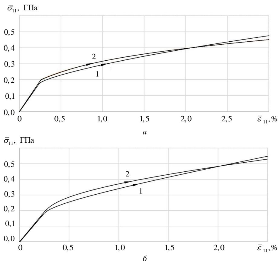
**Рис. 4.** Диаграммы деформирования  $\bar{\sigma}_{11} \sim \bar{\epsilon}_{11}$  композита при одноосном нагружении в поперечном направлении:
