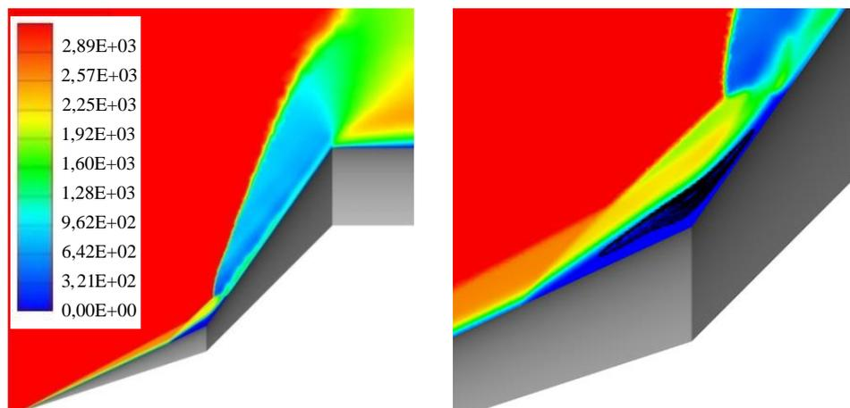
Рис. 7. Распределения продольной компоненты скорости (м/с) при высокоскоростном обтекании двойного конуса
