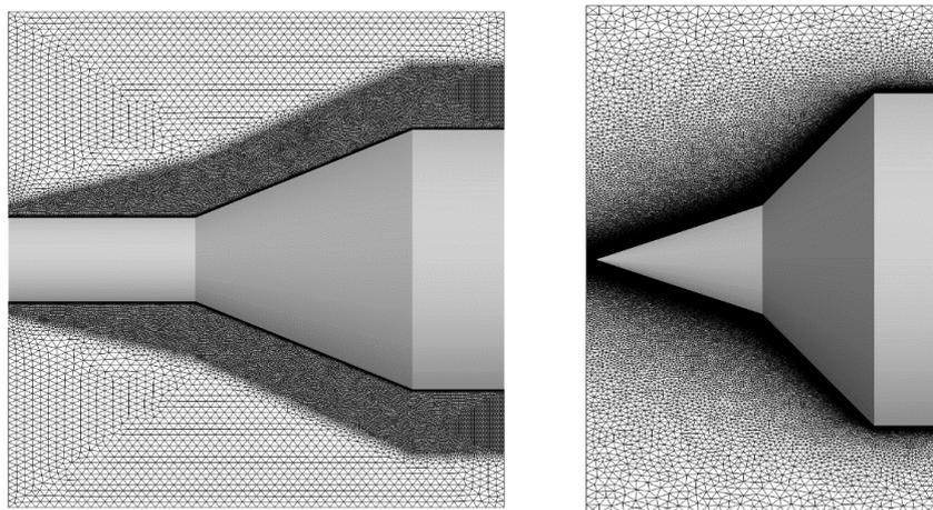
Рис. 2. Объемные сетки цилиндрически–конического тела и двойного конуса
