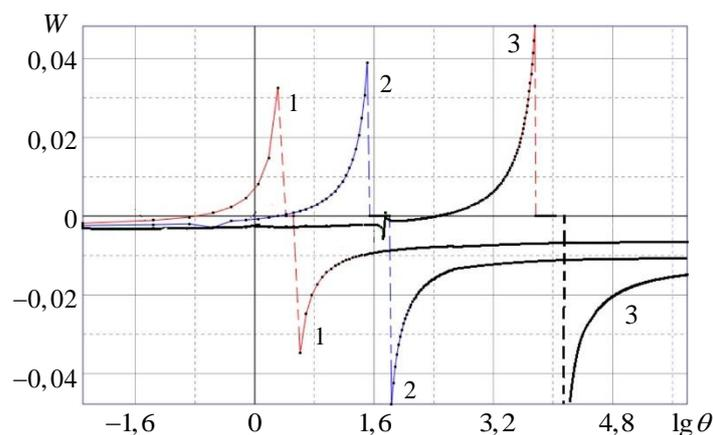
**Рис. 2.** Зависимость максимального прогиба  $W = u_3^{(0)}(0,5)$  от коэффициента скольжения  $\theta$  для двухслойной композитной пластины с различными схемами армирования:
