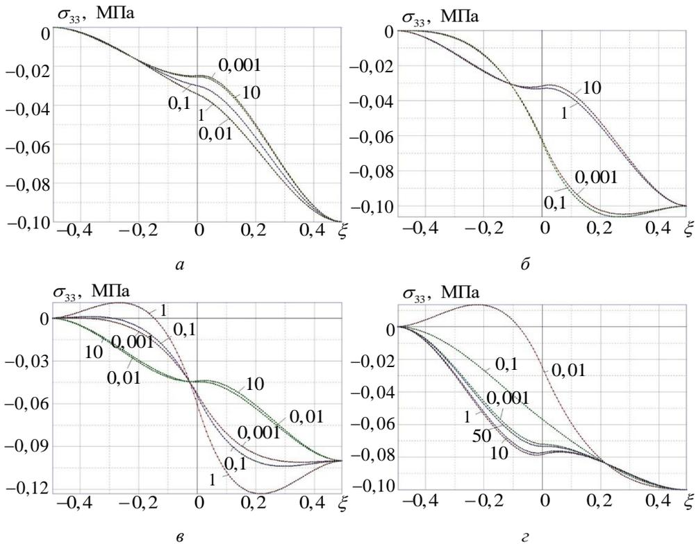
**Рис. 10.** Распределение по толщине поперечных напряжений в двухслойной композитной пластине для  $x_1 = 0$ , цифры у кривых — значения коэффициента скольжения  $\theta$ , для различных схем армирования:
