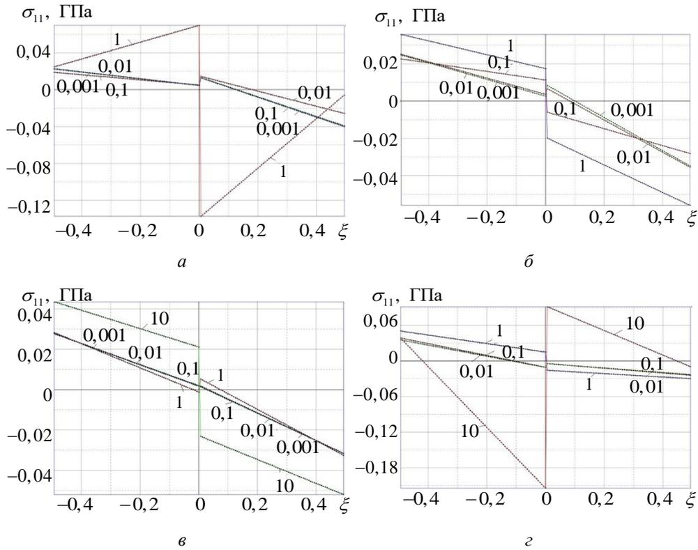
**Рис. 5.** Распределение по толщине изгибных напряжений в двухслойной композитной пластине для  $x_1 = 0$ , цифры у кривых — значения коэффициента скольжения  $\theta$ , для различных схем армирования:
