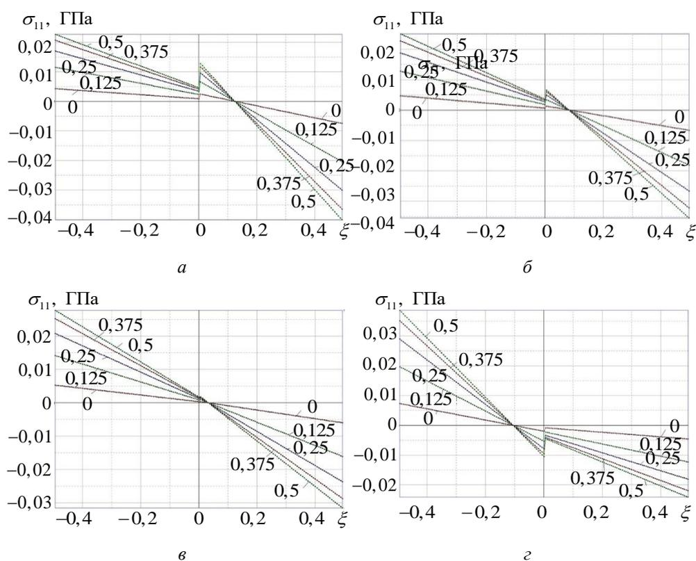
**Рис. 4.** Распределение по толщине изгибных напряжений в двухслойной композитной пластине для разных значений координаты  $x_1$  (0; 0,12; 0,25), при значении коэффициента проскальзывания слоев  $\theta = 0,001$ , для различных схем армирования:
