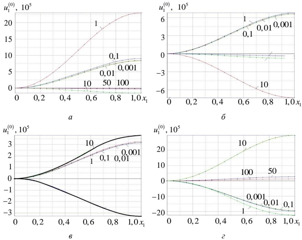
**Рис. 3.** Зависимость продольного перемещения двухслойной композитной пластины от продольной координаты  $x_1$ , цифры у кривых — значения коэффициента скольжения  $\theta$ , для различных схем армирования:
