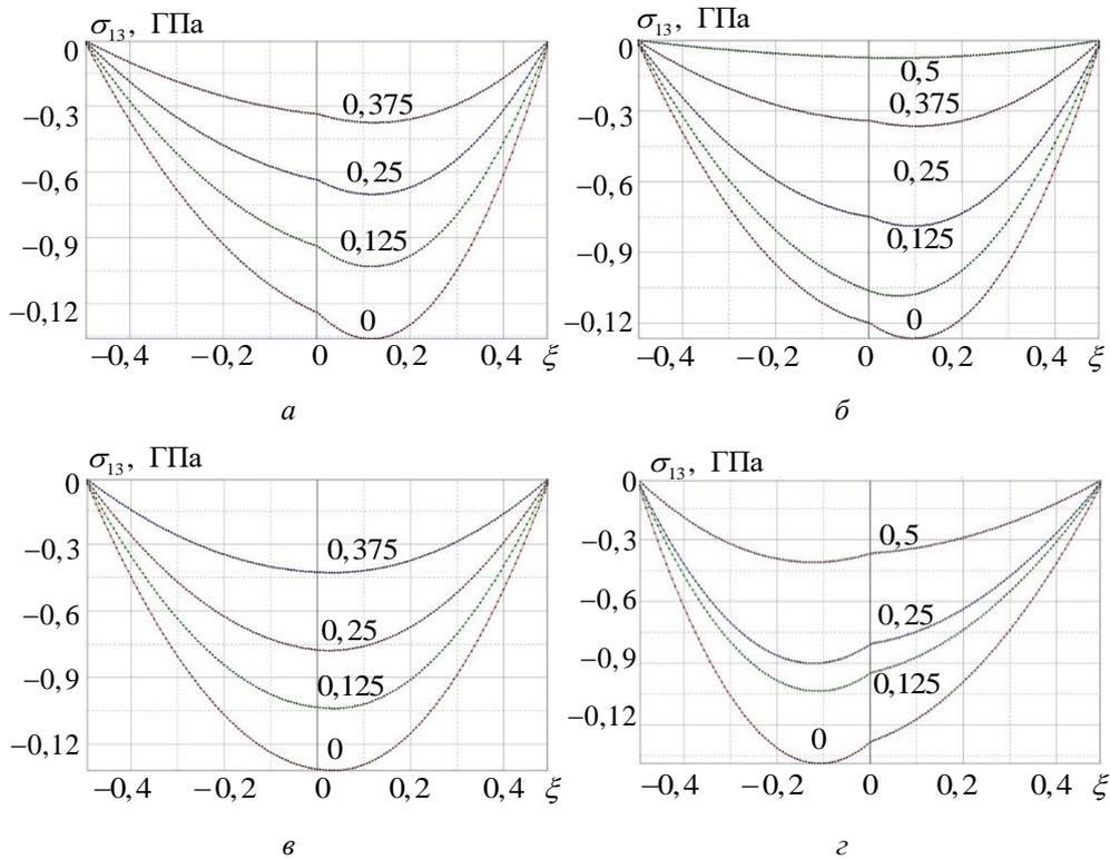
**Рис. 6.** Распределение по толщине напряжений межслойного сдвига в двухслойной композитной пластине для разных значений координаты  $x_1$  (0; 0,12; 0,25) при значении коэффициента проскальзывания слоев  $\theta = 0,001$ , для различных схем армирования:
