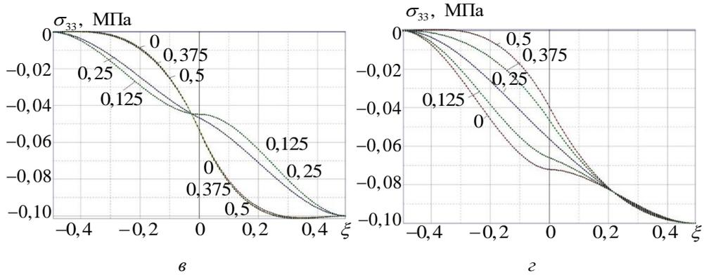
**Рис. 9.** Распределение по толщине изгибных напряжений в двухслойной композитной пластине для разных значений координаты  $x_1$  (0; 0,12; 0,25) при значении коэффициента проскальзывания слоев  $\theta = 0,001$ , для различных схем армирования:
