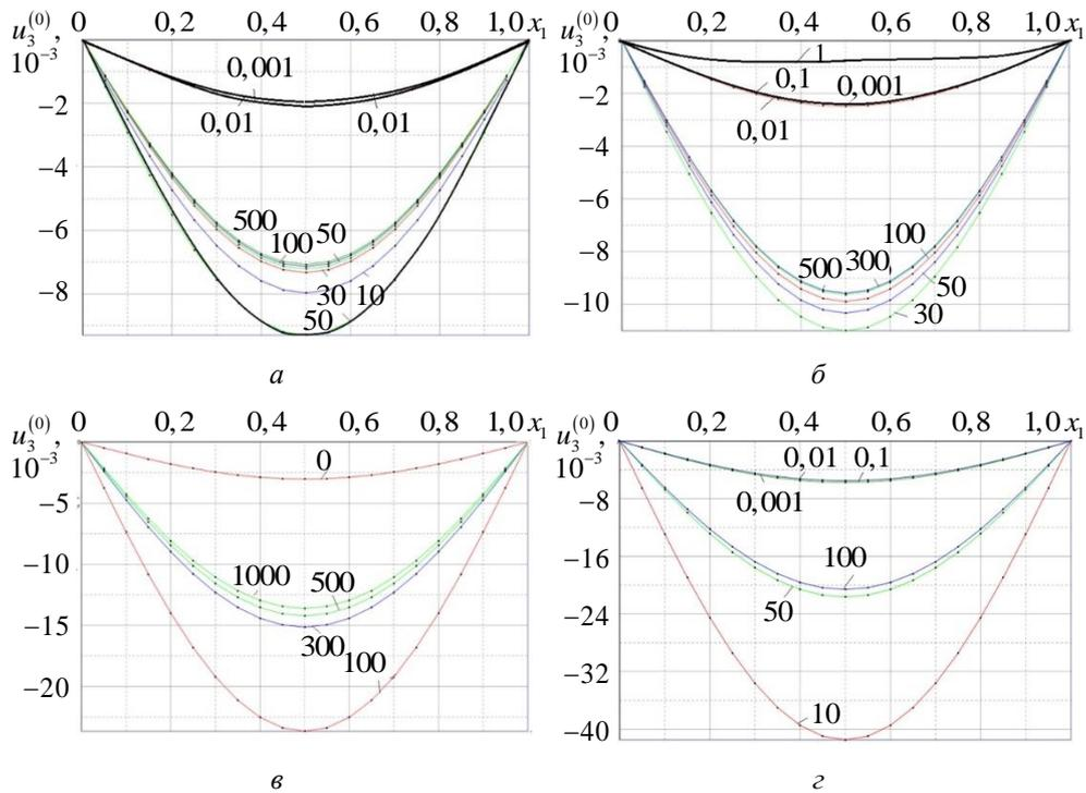
**Рис. 1.** Зависимость прогиба двухслойной композитной пластины с проскальзыванием, от продольной координаты  $x_1$ , цифры у кривых — значения коэффициента скольжения  $\theta$ , для различных схем армирования:
