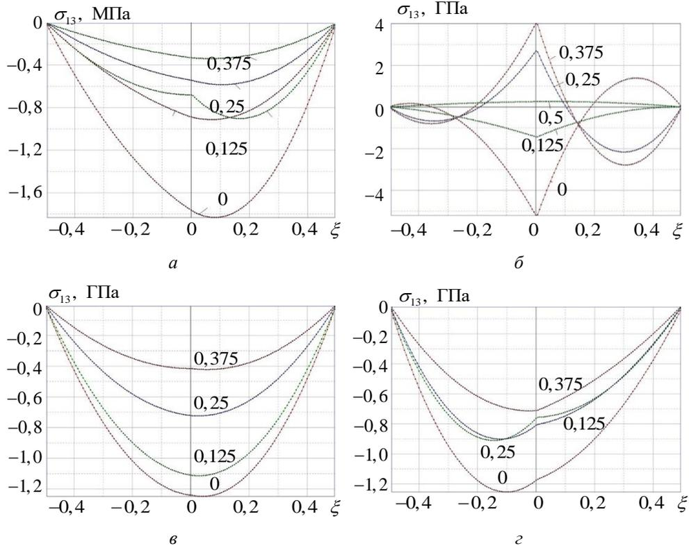
**Рис. 7.** Распределение по толщине напряжений межслойного сдвига в двухслойной композитной пластине для разных значений координаты  $x_1$  (0; 0,12; 0,25) при значении коэффициента проскальзывания слоев  $\theta = 0,01$ , для различных схем армирования:
