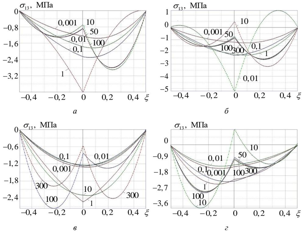
**Рис. 8.** Распределение по толщине напряжений межслойного сдвига в двухслойной композитной пластине для  $x_1 = 0$ , цифры у кривых — значения коэффициента скольжения  $\theta$ , для различных схем армирования:
