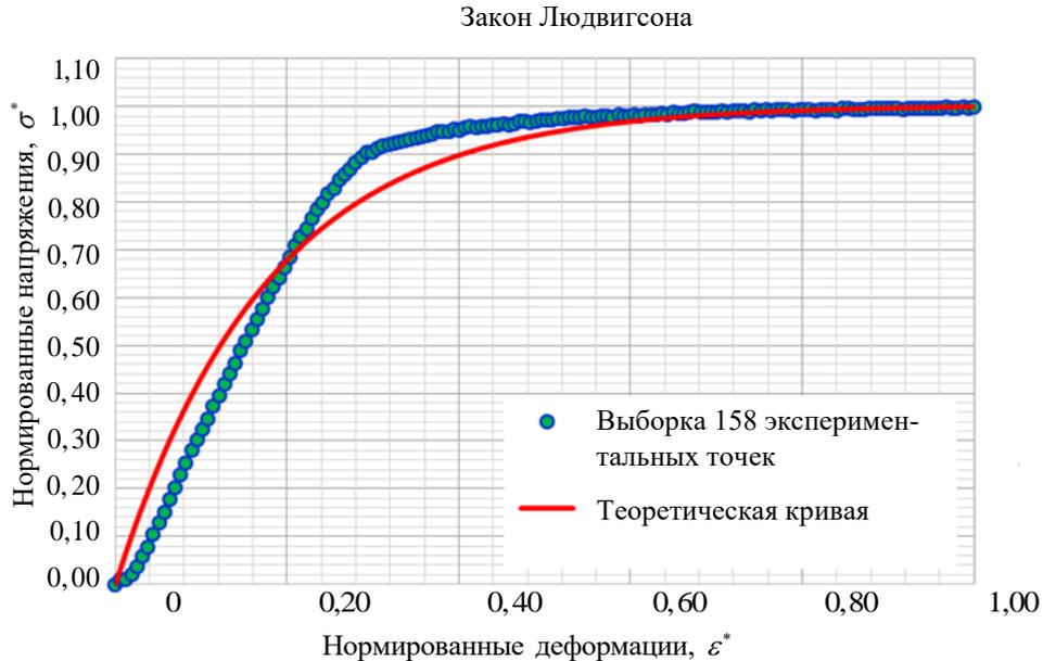
Рис. 3 Экспериментальная кривая титанового сплава ВТ6 и теоретическая кривая по закону Людвиговона
