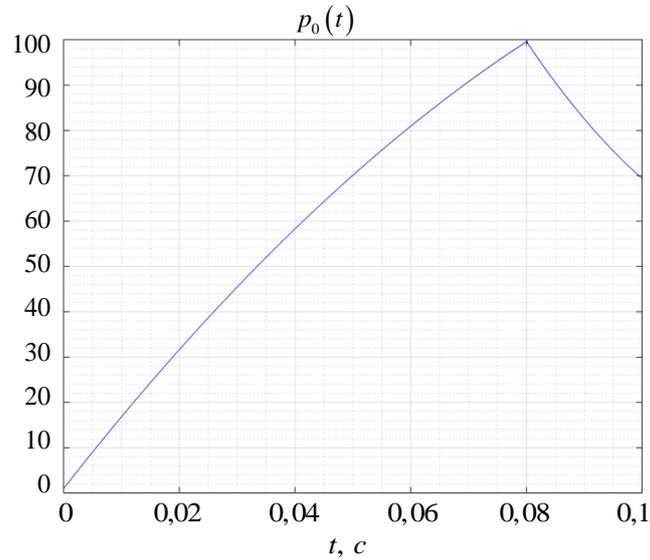
Рис. 2 График входного безразмерного давления от времени
