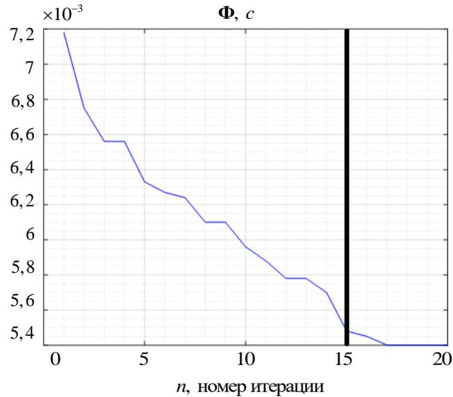
**Рис. 5.** Зависимость времени рассогласования относительного перемещения двух исполнительных органов от номера итерации комбинированного метода поиска. До 15 итерации применен ГА, далее ДМ.
