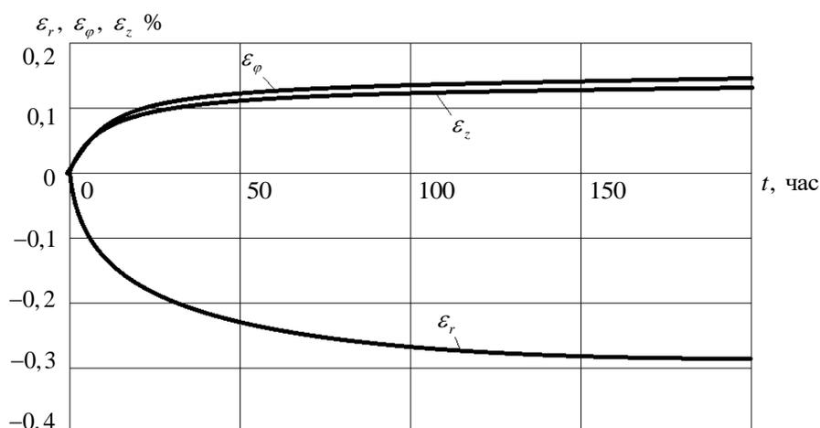
Рис. 5. Кривые деформаций цилиндрической оболочки в условиях ползучести
