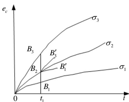
Рис. 1. Кривые ползучести при различных значениях постоянных напряжений согласно теории течения
