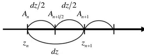
**Рис. 1.** Эскиз численного расчета по симметричной схеме, основанной на методах Рунге-Кутты и быстрого преобразования Фурье:
