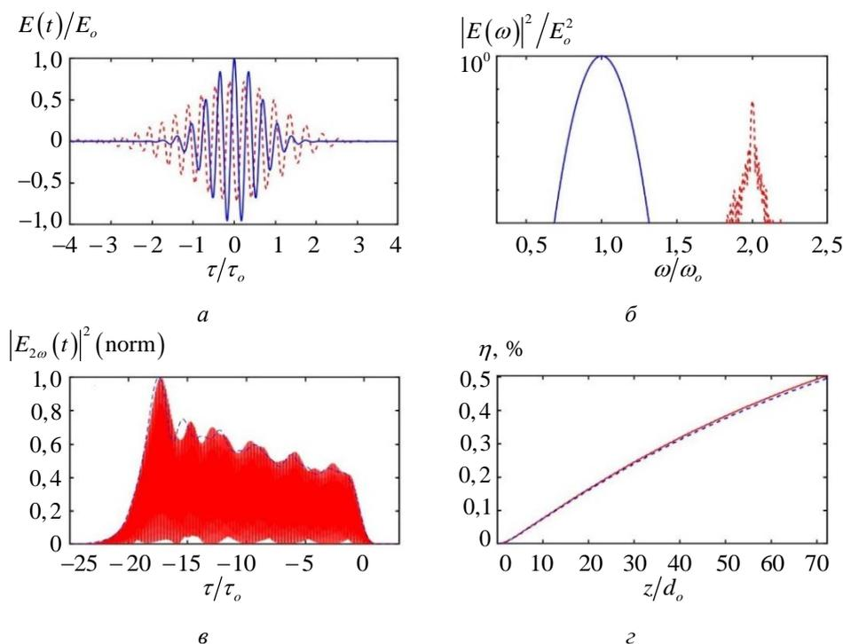
**Рис. 2.** Результаты численных расчетов для 10 фс: а — временной профиль поля; б — спектр поля; в — временной профиль интенсивности второй гармоники при выходе из кристалла; г — зависимость эффективности ГВГ от числа доменов
