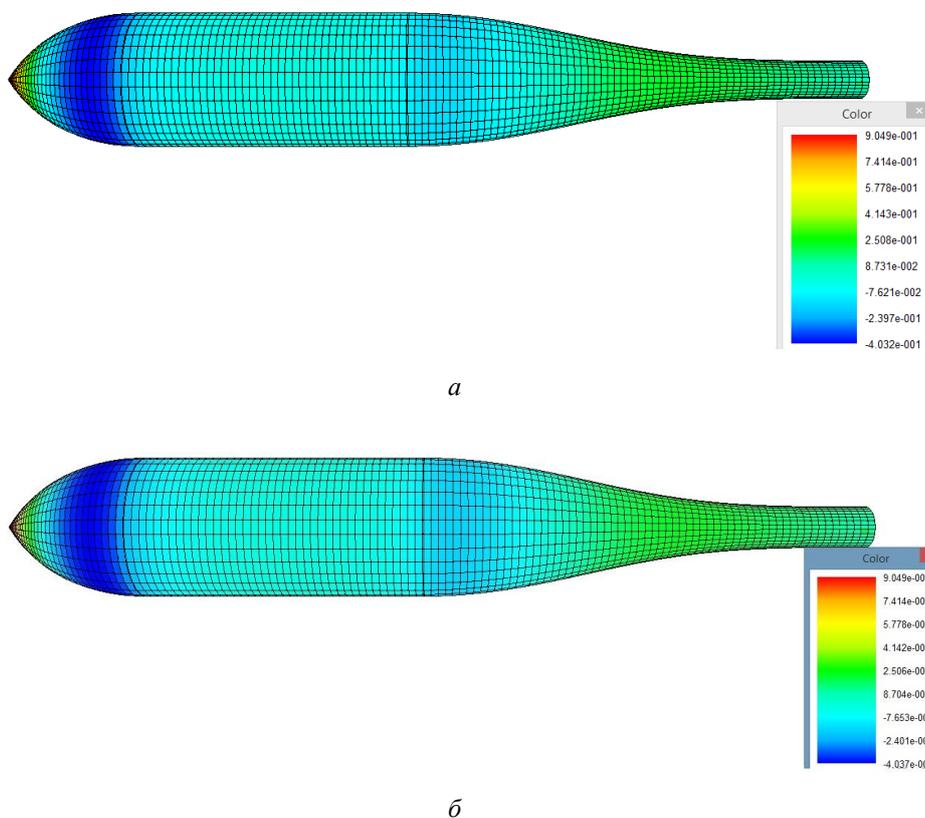
**Рис. 4.** Формы эквивалентной поверхности и распределение коэффициента давления  $c_p$  при обтекании тела с  $L_g = 1$  и  $L_c = 2$  при  $\alpha = 0^\circ$  и  $Re = 5 \cdot 10^6$  :
