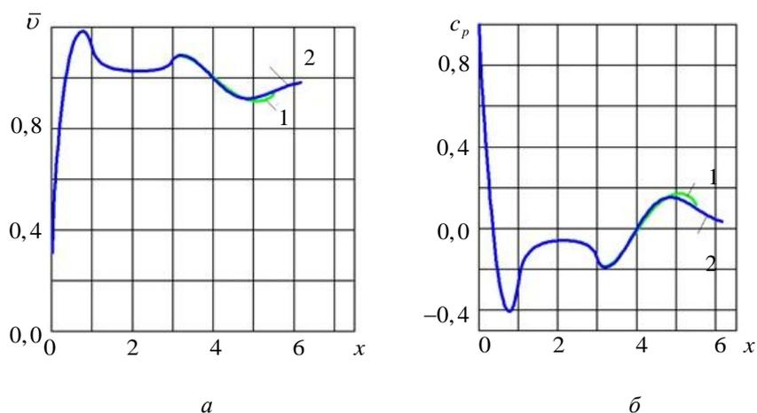
**Рис. 6.** Зависимости параметров потока газа в продольном сечении поверхности эквивалентного тела от координаты  $x$  при обтекании тела с  $L_g = 1$  и  $L_c = 2$  при  $\alpha = 0^\circ$  и  $Re = 5 \cdot 10^6$ :
