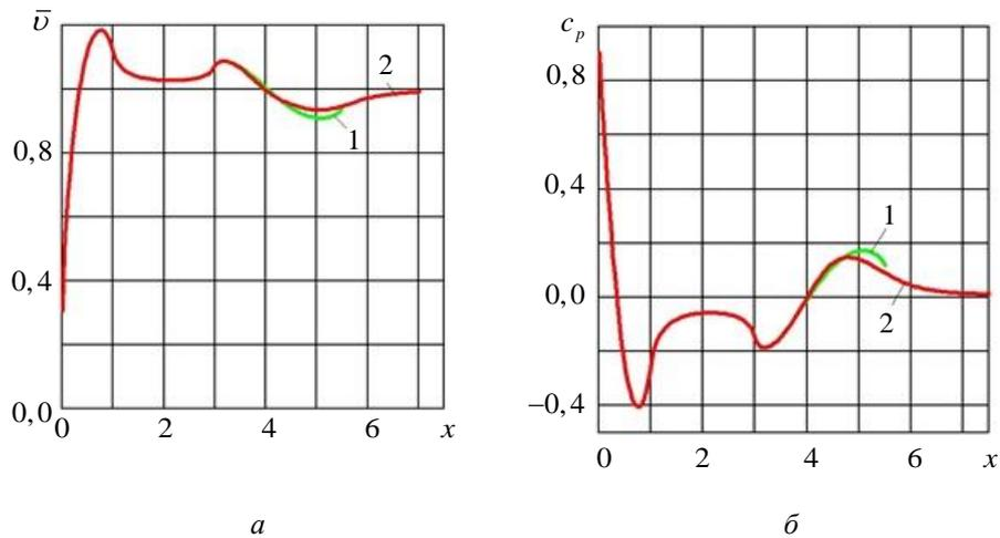
**Рис. 5.** Зависимости параметров потока газа в продольном сечении поверхности эквивалентного тела от координаты  $x$  при обтекании тела с  $L_g = 1$  и  $L_c = 2$  при  $\alpha = 0^\circ$  и  $Re = 5 \cdot 10^6$ :
