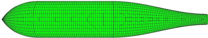
**Рис. 2.** Окончательная форма эквивалентной поверхности при обтекании тела  $L_g = 1$  и  $L_c = 2$  при  $\alpha = 0^\circ$  и  $Re = 5 \cdot 10^6$  для первого варианта функции
