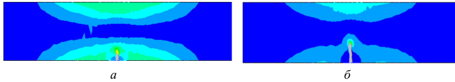
Рис. 5. Поле эффективных напряжений в момент развития квазитрещины: a — 3,25 \cdot 10^9 циклов от начала и 1,1 \cdot 10^6 циклов от момента зарождения; b — в момент разрушения образца, 1,3 \cdot 10^6 циклов от момента зарождения
