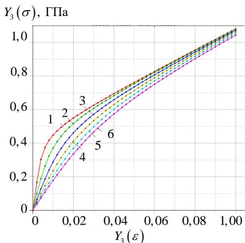
**Рис. 6.** Диаграммы деформирования  $Y_3(\sigma) = \bar{F}_3(Y_3(\varepsilon), Y_{2\max}(\varepsilon))$  для ДАКМ, полученные по траекториям № 4 с помощью прямого решения задач  $L_{pq}$  (кривые —1) для различных значениях  $Y_{2\max}(\varepsilon) = 0$  (1); 0,01 (2); 0,02 (3); 0,03 (4); 0,04 (5) и 0,05 (6)
