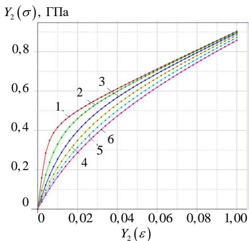
**Рис. 4.** Диаграммы деформирования для ДАКМ, полученные по траекториям № 4 с помощью прямого решения задач  $L_{pq}$  для различных значениях  $Y_{3\max}(\varepsilon)$ : 0 (1); 0,01 (2); 0,02 (3); 0,03 (4); 0,04 (5) и 0,05 (6)
