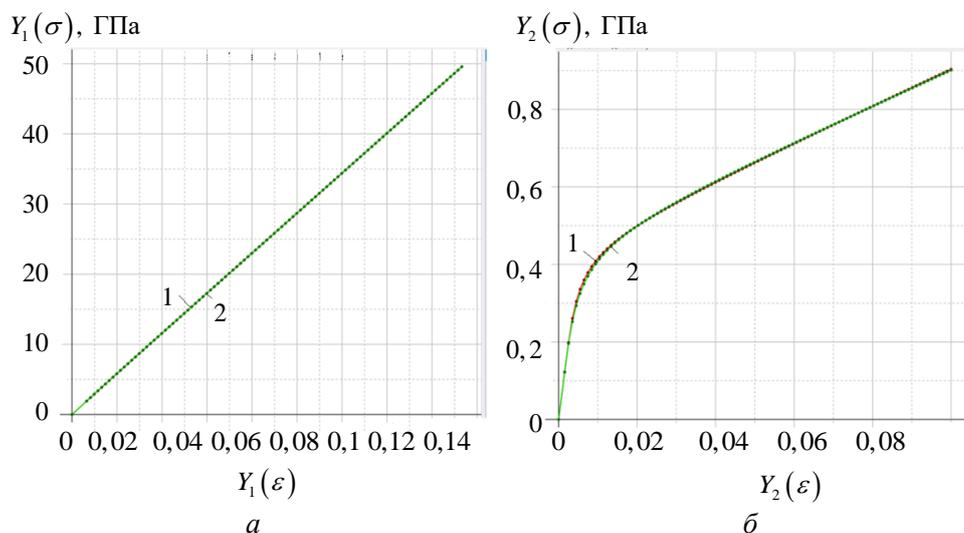
**Рис. 3.** Диаграммы деформирования для ДАКМ, полученные по траекториям № 2 и 3 с помощью прямого решения задач  $L_{pq}$  (кривые — 1) и аппроксимации по формулам (47) и (55) (кривые — 2):
