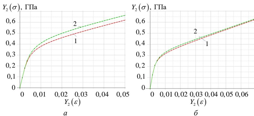
**Рис. 8.** Диаграммы деформирования  $Y_2(\sigma) = \bar{F}_2(Y_2(\varepsilon))$  для ДАКМ, полученные с помощью прямого решения задач  $L_{pq}$  (кривые — 1) и с помощью микроструктурной модели (кривые — 2) по траекториям:  $a$  —  $\{\dot{\sigma}\} = \{2, 0, 5, 0, 5, 0, 0, 0\}$ ;  $b$  —  $\{\dot{\sigma}\} = \{1, -0, 5, -0, 5, 1, 0, 0\}$
