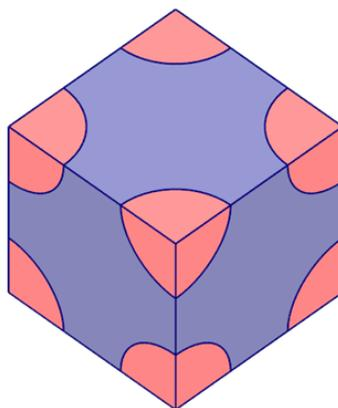
Рис. 1. ЯП дисперсно-армированного КМ с частицами сферической формы
