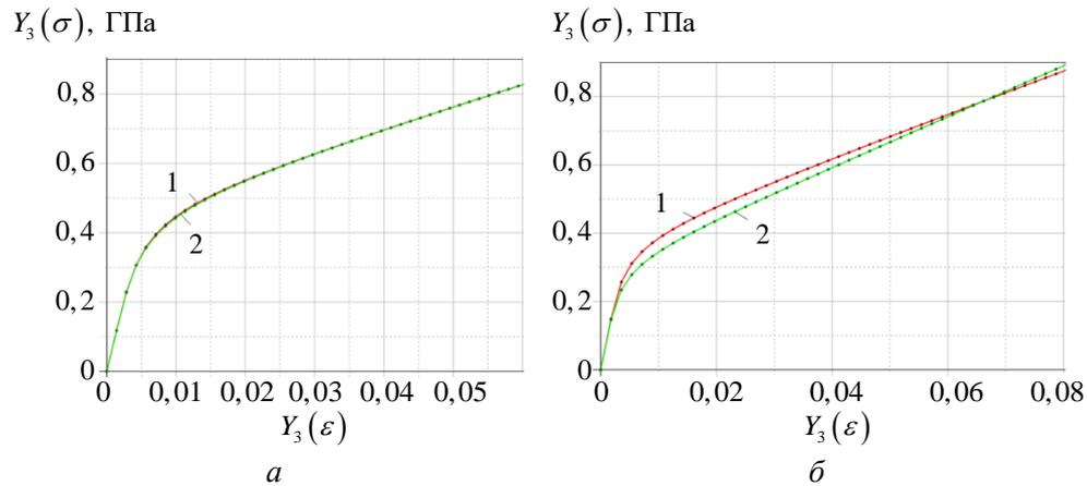
**Рис. 9.** Диаграммы деформирования  $Y_3(\sigma) = \bar{F}_3(Y_3(\varepsilon))$  для ДАКМ, полученные с помощью прямого решения задач  $L_{pq}$  (кривые —1) и с помощью микроструктурной модели (кривые — 2) по траекториям:  $a — \{\dot{\sigma}\} = \{2, 0, 5, 0, 5, 0, 0, 0\}$ ;  $b — \{\dot{\sigma}\} = \{1, -0, 5, -0, 5, 1, 0, 0\}$
