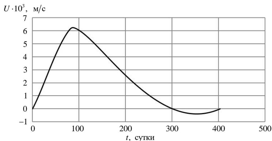
Рис. 2. Радиальная составляющая скорости полета в оптимальном процессе
