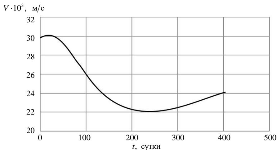
Рис. 3. Тангенциальная составляющая скорости полета в оптимальном процессе
