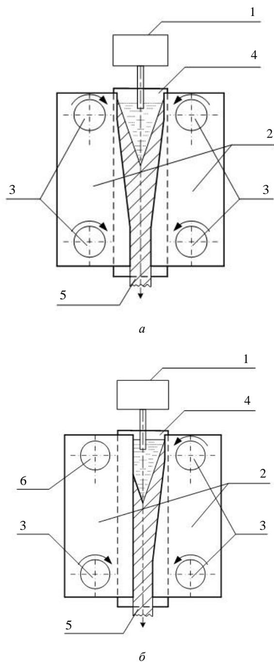
**Рис. 1.** Схемы конструкций литейно-ковочного модуля:
