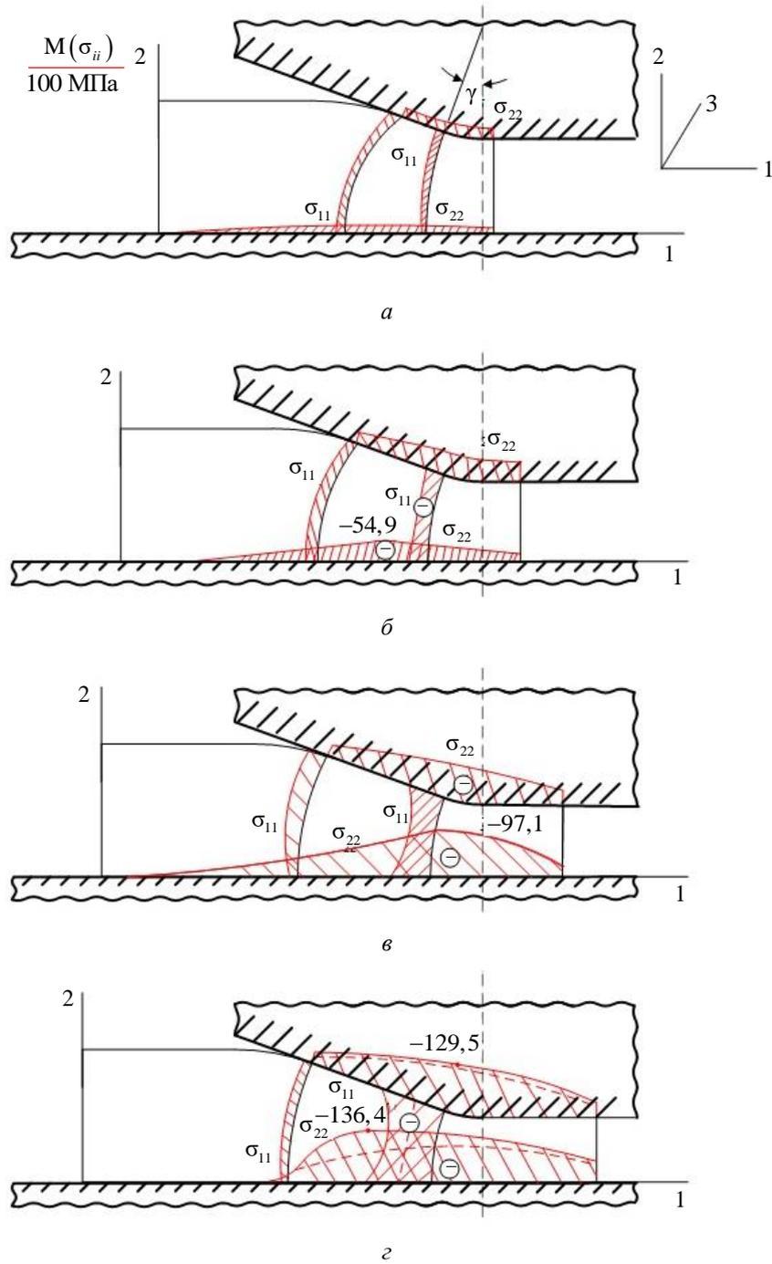
**Рис. 8.** Эпюры напряжений  $\sigma_{11}$  и  $\sigma_{22}$  при  $h_0 = 30$  мм,  $h_1 = 8$  мм в плоскости симметрии  $x_3 = 0$  для угла поворота приводного вала:  $a$  —  $\alpha = 30^\circ$ ;  $б$  —  $\alpha = 60^\circ$ ;  $в$  —  $\alpha = 90^\circ$ ;  $г$  —  $\alpha = 120^\circ$ ;  $---$  — способу деформации на рис. 1,  $a$  при котором принималось  $h_0 = 15$  мм,  $h_1 = 4$  мм
