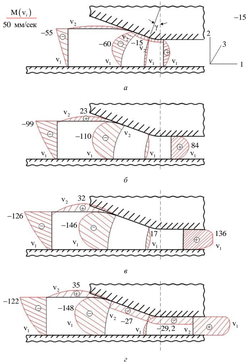
**Рис. 7.** Эпюры скоростей металла  $v_1$  и  $v_2$  при  $h_0 = 30$  мм,  $h_1 = 8$  мм в плоскости симметрии  $x_3 = 0$  для угла поворота приводного вала: а —  $\alpha = 30^\circ$ ; б —  $\alpha = 60^\circ$ ; в —  $\alpha = 90^\circ$ ; г —  $\alpha = 120^\circ$ ; д —  $\alpha = 120^\circ$
