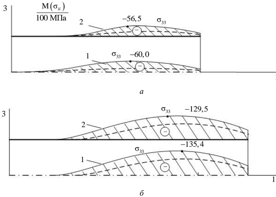
**Рис. 9.** Эпюры напряжений  $\sigma_{33}$  при  $h_0 = 30$  мм,  $h_1 = 8$  мм для угла поворота приводного вала:
