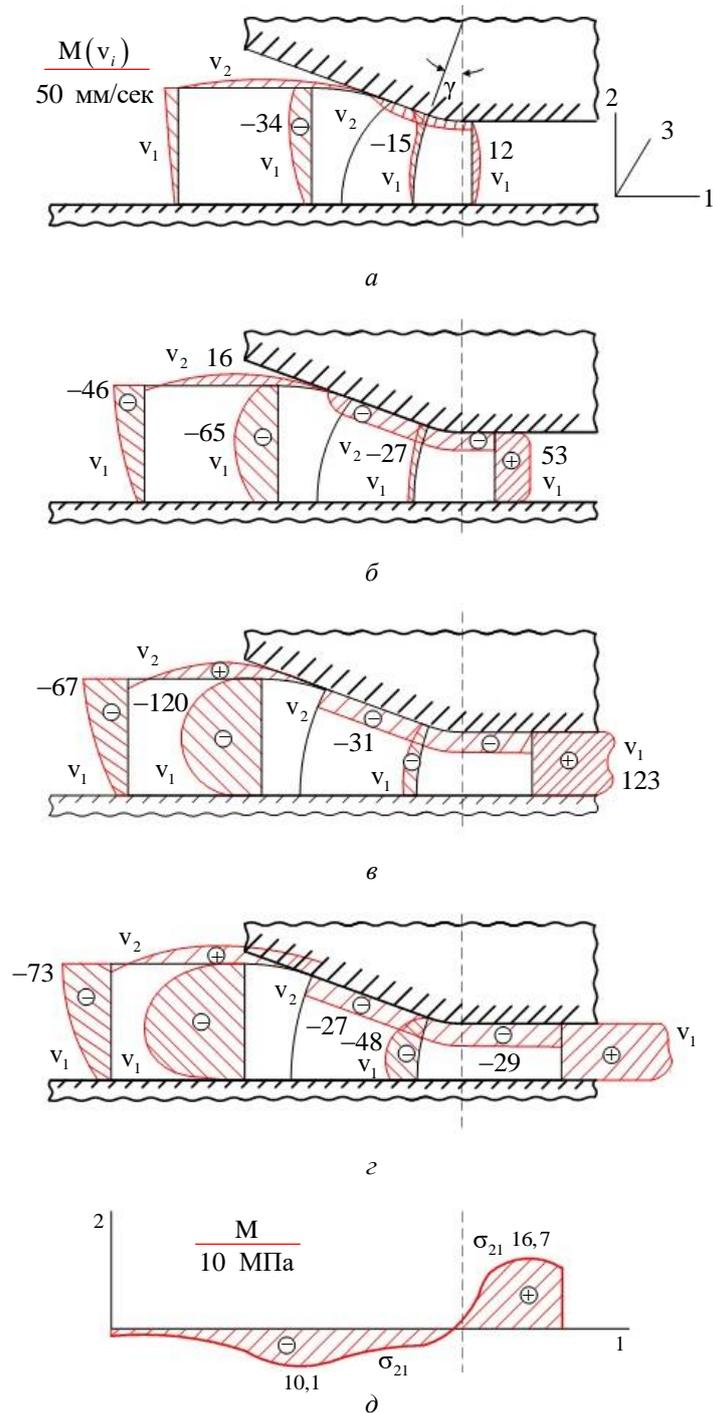
**Рис. 4.** Эпюры скоростей металла  $v_1, v_2$  и эпюра касательного напряжения  $\sigma_{21}$  на неподвижном бойке при  $h_0 = 15 \text{ мм}$ ,  $h_1 = 4 \text{ мм}$  в плоскости симметрии  $x_3 = 0$  для угла поворота приводного вала:  $a$  —  $\alpha = 30^\circ$ ;  $б$  —  $\alpha = 60^\circ$ ;  $в$  —  $\alpha = 90^\circ$ ;  $г$  —  $\alpha = 120^\circ$ ;  $д$  —  $\alpha = 120^\circ$
