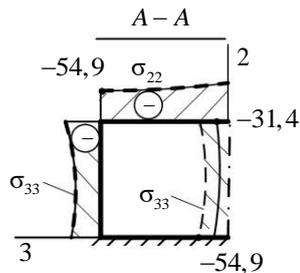
**Рис. 10.** Эпюры напряжений  $\sigma_{22}$  и  $\sigma_{33}$  по способу на рис. 1,  $b$  в поперечном сечении  $A-A$  для угла поворота приводного вала:
