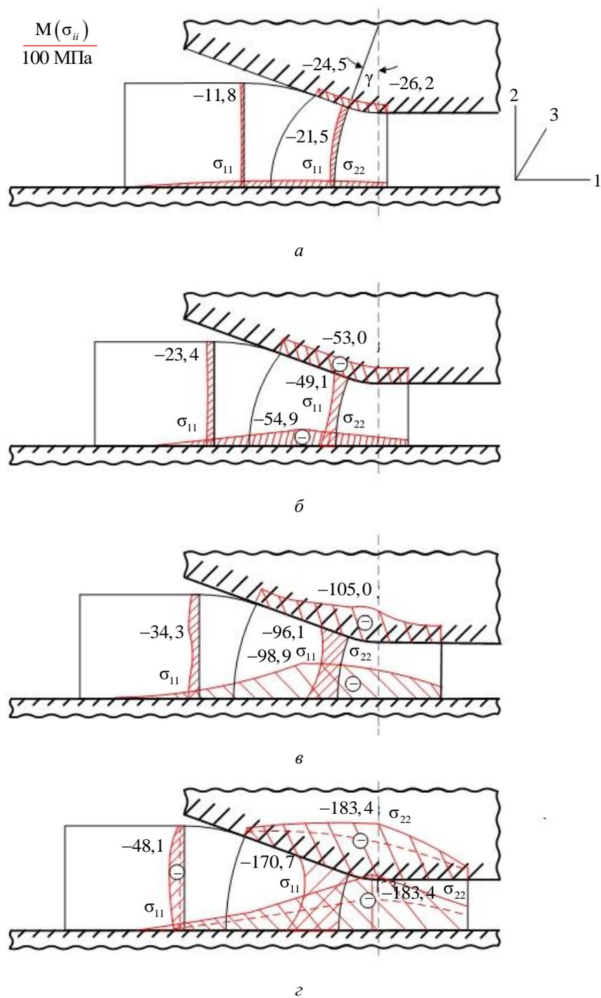
**Рис. 5.** Эпюры напряжений  $\sigma_{11}$  и  $\sigma_{22}$  при  $h_0 = 15$  мм,  $h_1 = 4$  мм в плоскости симметрии  $x_3 = 0$  для угла поворота приводного вала:  $a$  —  $\alpha = 30^\circ$ ;  $б$  —  $\alpha = 60^\circ$ ;  $в$  —  $\alpha = 90^\circ$ ;  $г$  —  $\alpha = 120^\circ$ ;  $---$  — постановка задачи при отсутствии трения на неподвижном бойке
