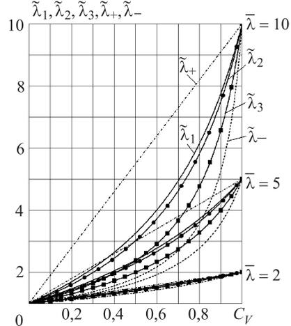
**Рис. 3.** Графики зависимостей при  $\bar{\lambda} > 1$  верхней  $\tilde{\lambda}_+$  и нижней  $\tilde{\lambda}_-$  оценок эффективного коэффициента теплопроводности и оценок  $\tilde{\lambda}_1$  —  $\tilde{\lambda}_3$  от объемной концентрации  $C_V$
