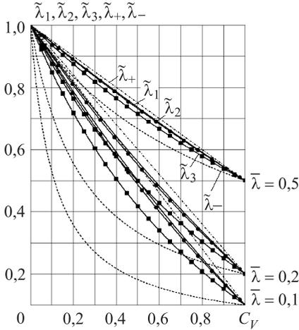
**Рис. 2.** Графики зависимостей при  $\bar{\lambda} < 1$  верхней  $\tilde{\lambda}_+$  и нижней  $\tilde{\lambda}_-$  оценок эффективного коэффициента теплопроводности и оценок  $\tilde{\lambda}_1$  —  $\tilde{\lambda}_3$  от объемной концентрации  $C_V$
