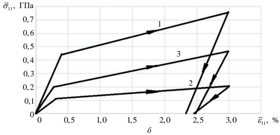
**Рис. 1.** Диаграммы деформирования  $\bar{\sigma}_{11} \sim \bar{\epsilon}_{11}$  при одноосном растяжении в продольном направлении:
