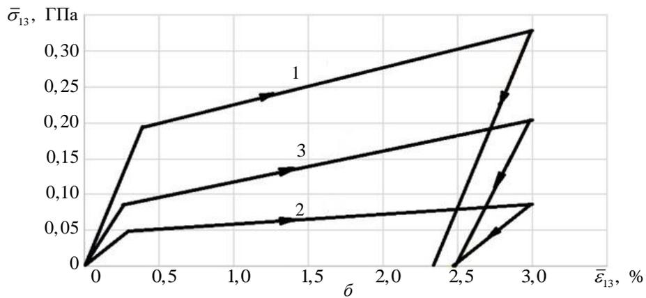
**Рис. 3.** Диаграммы деформирования  $\bar{\sigma}_{33} \sim \bar{\epsilon}_{33}$  при одноосном растяжении в продольном направлении:
