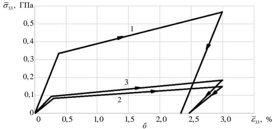
**Рис. 2.** Диаграммы деформирования  $\bar{\sigma}_{33} \sim \bar{\epsilon}_{33}$  при одноосном растяжении в продольном направлении:
