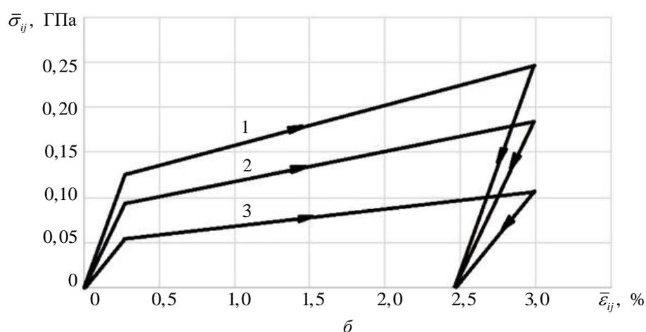
**Рис. 4.** Диаграммы деформирования  $\bar{\sigma}_{ij} \sim \bar{\epsilon}_{ij}$  композита сталь/алюминий, при различных видах нагружения и разгрузки
