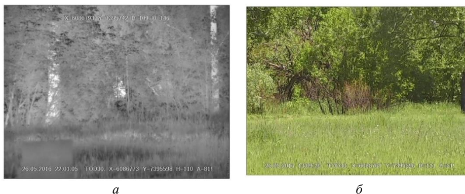
Рис. 1. Изображения участков лесистой местности, снятой оптико-электронными средствами: а — изображение с тепловизора; б — изображение с дневной камеры
