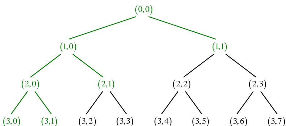
Рис. 1. Схема вейвлет-пакетного разложения сигнала
