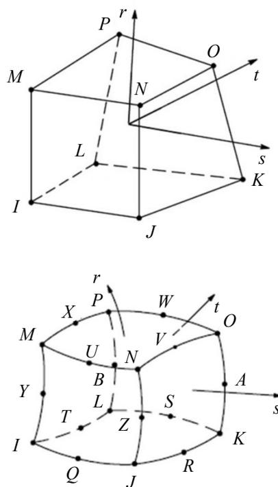
Рис. 1. Пример линейного (слева) и квадратичного (справа) гексаэдральных конечных элементов, используемых в пакете ANSYS (заимствовано из [6])
