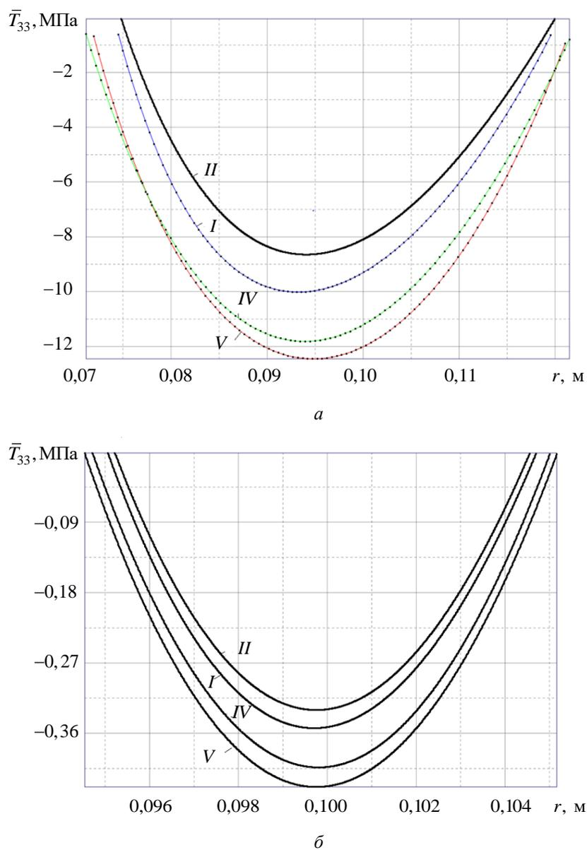
Рис. 5. Распределение компоненты  $\bar{T}_{33}(r)$  тензора напряжений Коши, вычисленной по формуле (51), по радиусу  $r$  панели при цилиндрическом изгибе (цифры у кривых — номер  $n$  модели  $B_n$ )
