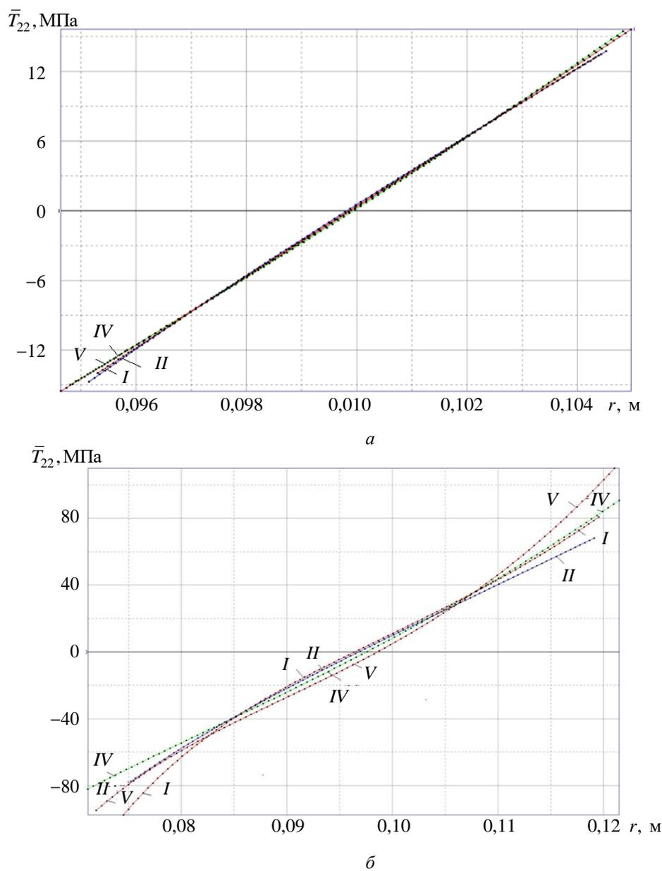
**Рис. 4.** Распределение компоненты  $\bar{T}_{22}(r)$  тензора напряжений Коши, вычисленной по формуле (51), по радиусу  $r$  панели при цилиндрическом изгибе (цифры у кривых — номер  $n$  модели  $B_n$ )
