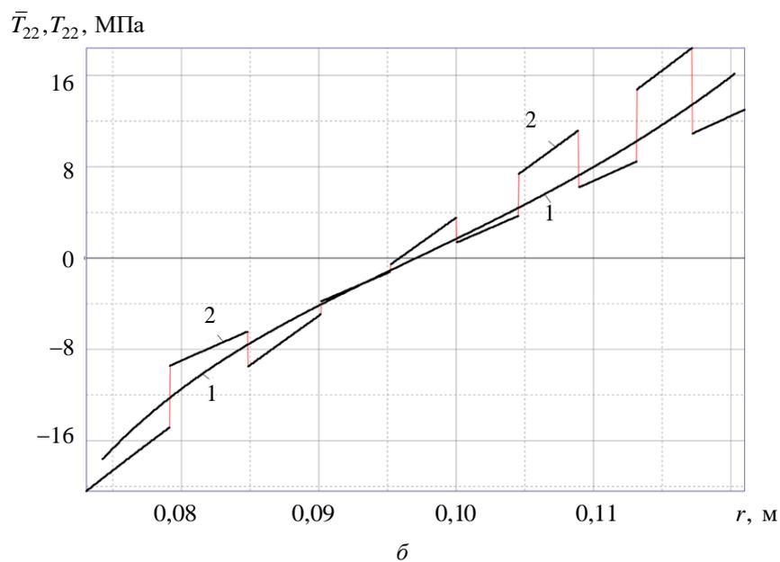
**Рис. 7.** Распределение по радиусу  $r$  средних напряжений  $\bar{T}_{22}$  (кривая 1) и истинных напряжений  $T_{22}$  в слоях (кривая 2) композитной панели при цилиндрическом изгибе (модель  $B_I$ )
