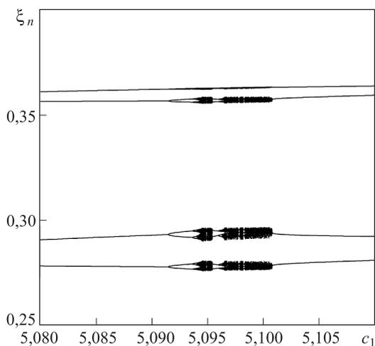
Рис. 7. «Матрешечная» структура в системе (3):  $5,08 \leq c_1 \leq 5,11$ ;  $c_2 = -6$ ;
