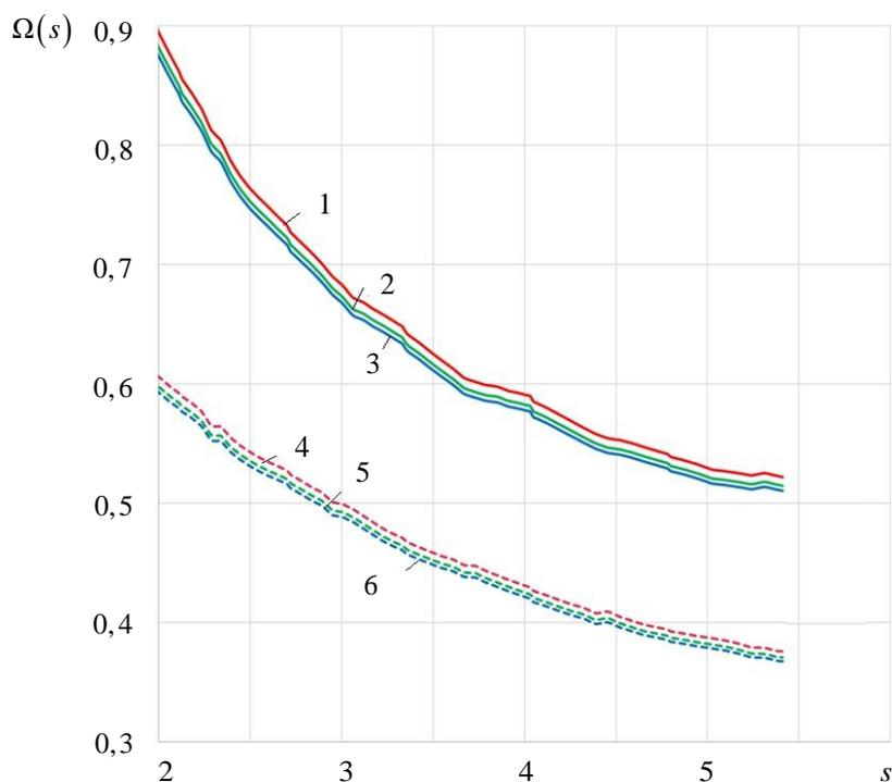
**Рис. 2.** Влияние давления торможения  $p_0$  на зависимость критерия теплообмена  $\Omega(s)$  от координаты  $s$ , для случая, когда давление  $p_0$  задано на наветренной стороне (1 — 0,001 атм, 2 — 10,000 атм, 3 — 0,100 атм) и подветренной стороне (4 — 0,001 атм, 5 — 10,000 атм, 6 — 0,100 атм)
