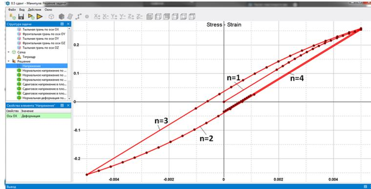
Рис. 3. Окно ПК SMCM, показывающее единую диаграмму циклического деформирования  $\bar{\sigma}_{13} = F_{13}(\bar{\epsilon}_{13})$  ДАКМ Al/SiC для случая 4-х циклов сдвигового деформирования: (циклы нагружения  $n = 1, n = 3$  и циклы разгрузки  $n = 2, 4$ ) (напряжения  $\Delta\bar{\sigma}_{13}^{(n)}$ , ГПа)
