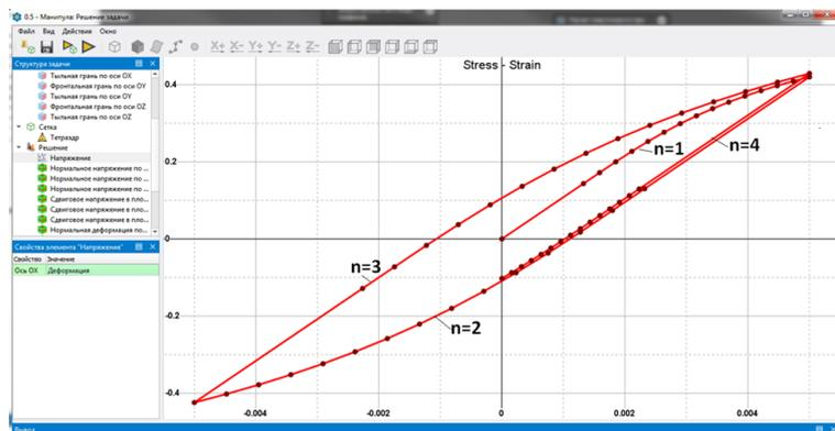
Рис. 2. Окно ПК SMCM, показывающее единую диаграмму циклического деформирования  $\bar{\sigma}_{11} = F_{11}(\bar{\varepsilon}_{11})$  ДАКМ Al/SiC для случая 4-х циклов одноосного растяжения – сжатия: (циклы нагружения  $n = 1, n = 3$  и циклы разгрузки  $n = 2, 4$ ) (напряжения  $\Delta \bar{\sigma}_{11}^{(n)}$ , ГПа)
