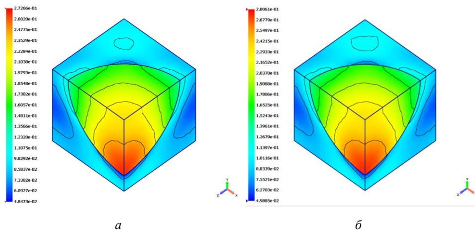
Рис. 5. Поля микронапряжений  $\Delta\sigma_{13(13)}^{(n)}$  (ГПа) в ЯП при циклическом деформировании на 1–м (а) и 15–м (б) цикле нагружения ДАКМ Al/SiC
