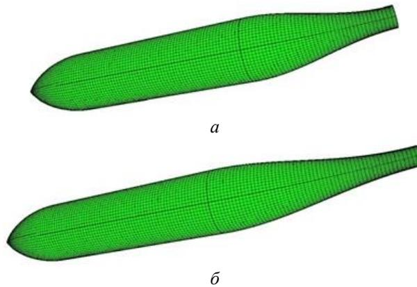
**Рис. 4.** Эквивалентные поверхности для оживально-цилиндрического тела с  $l_g = 1,25$  и  $l_c = 3$  при  $Re = 5 \cdot 10^6$  и  $\alpha = 4^\circ$  :
