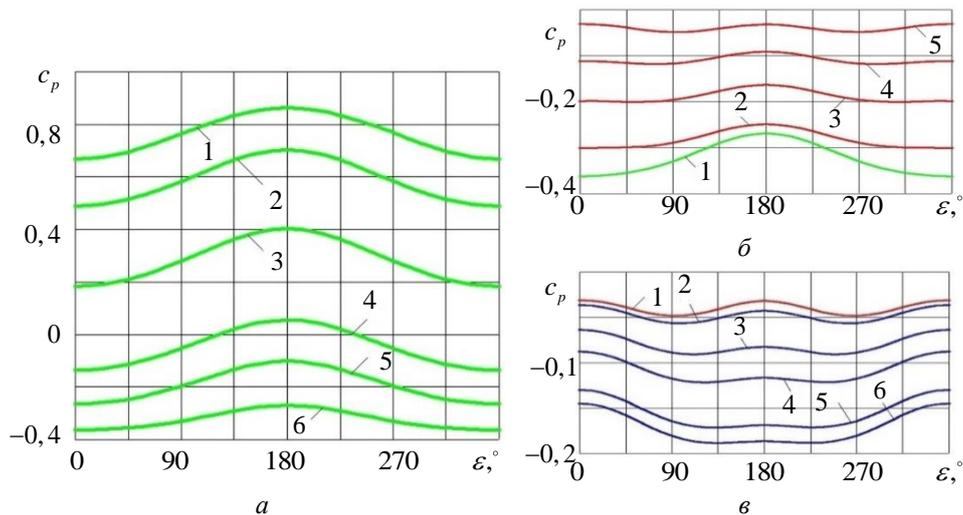
**Рис. 7.** Зависимость коэффициента давления  $c_p$  на поверхности обтекаемого тела от угла  $\varepsilon$ :
