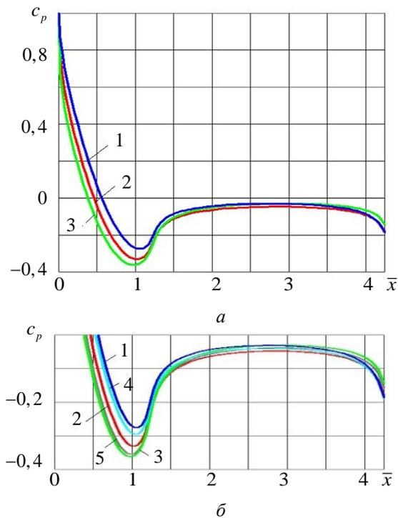
**Рис. 6.** Зависимости коэффициента давления  $c_p$  на поверхности обтекаемого тела с  $l_g = 1,25$  и  $l_c = 3$  от безразмерной продольной координаты  $\bar{x}$  при  $Re = 5 \cdot 10^6$  и  $\alpha = 4^\circ$  различных продольных сечениях (1 —  $\varepsilon = 0^\circ$ , 2 —  $\varepsilon = 90^\circ$ , 3 —  $\varepsilon = 180^\circ$ , 4 —  $\varepsilon = 45^\circ$ , 5 —  $\varepsilon = 135^\circ$ )
