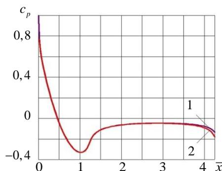
**Рис. 3.** Изменения коэффициента давления  $c_p$  в боковом сечении ( $\varepsilon = 90^\circ$ ) оживально-цилиндрического тела с  $l_g = 1,25$  и  $l_c = 3$  при  $Re = 5 \cdot 10^6$  и  $\alpha = 4^\circ$  :
