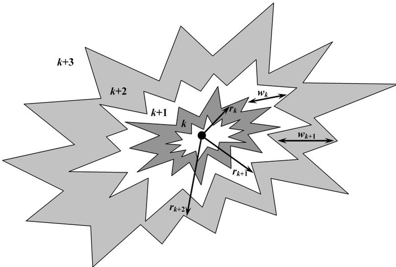
**Рис. 1.** Схематичное представление слоев опрокидывания. Увеличение номера слоя соответствует уменьшению кратности опрокидывания. Изрезанность границ слоев обеспечивает возрастание их ширины вместе с радиусом (в случае гладкой границы слои имели бы постоянную ширину)
