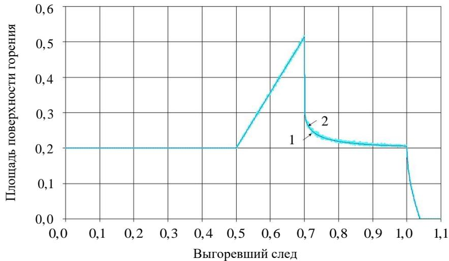
**Рис. 4.** Площадь поверхности горения плоского заряда угловой формы
