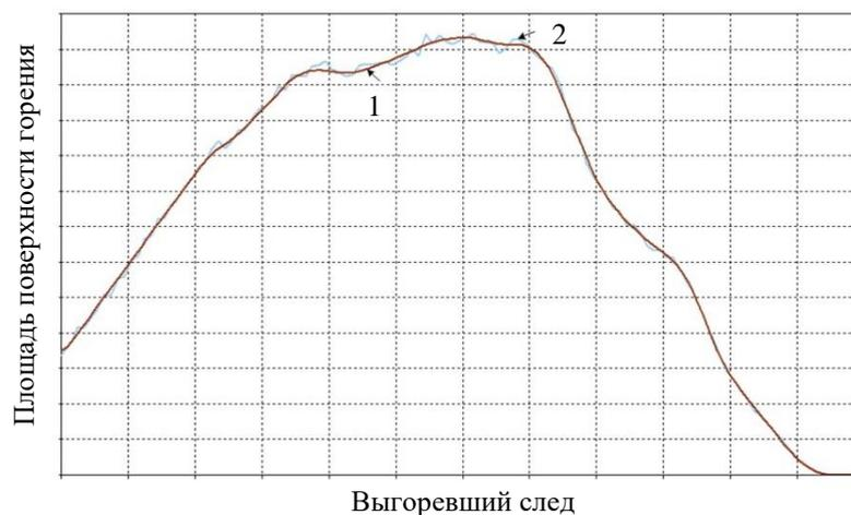
**Рис. 9.** Сопоставление по точности двух методов расчета площади поверхности горения цилиндро–конического заряда [22]
