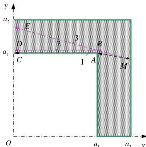
Рис. 3. Геометрия плоского заряда угловой формы ( $a_1=0,5$ ,  $a_2=0,7$ )
