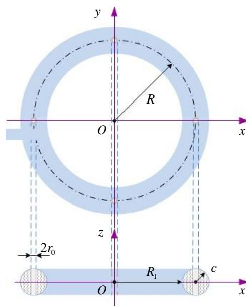
Рис. 7. Геометрия тороидального заряда с внутренними каналами ( $R=0,6$ ,  $c=0,1$ ,  $R_1=R-c=0,5$ ,  $r_0=0,01$ )
