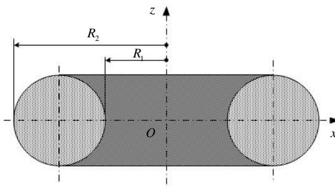
Рис.1. Геометрия тороидального заряда ( $R_1 = 0,5$ ,  $R_2 = 0,7$ )
