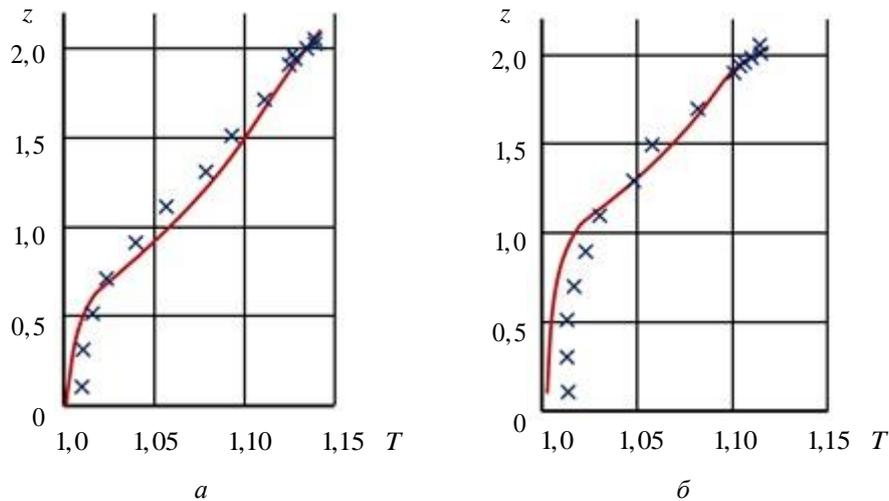
**Рис. 12.** Сравнение расчетных и экспериментальных данных по температуре в азотном баке в момент времени  $t = 0,6$ ,
