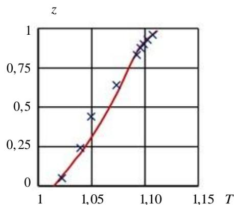
**Рис. 10.** Сравнение расчетного начального профиля температуры пара с опытными данными  $\varphi = 0,5$ ,  $Q = 1,2$  Вт
