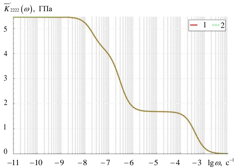
Рис. 8. Функции \bar{K}_{2222}(\omega) в полулогарифмических координатах для 1D композита:
