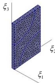
**Рис. 5.** КЭ сетка для ЯП 1D композита
