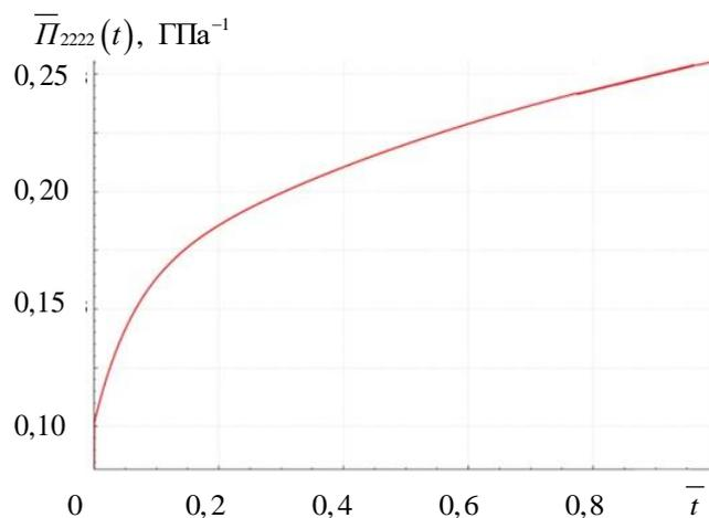
Рис. 15. Эффективная функция ползучести 1D композита  $\bar{P}_{2222}(t)$
