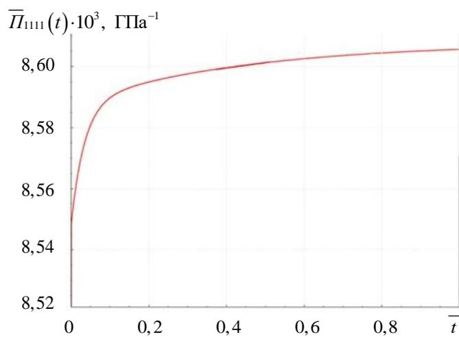
Рис. 12. Эффективная функция ползучести 1D композита  $\bar{P}_{1111}(t)$
