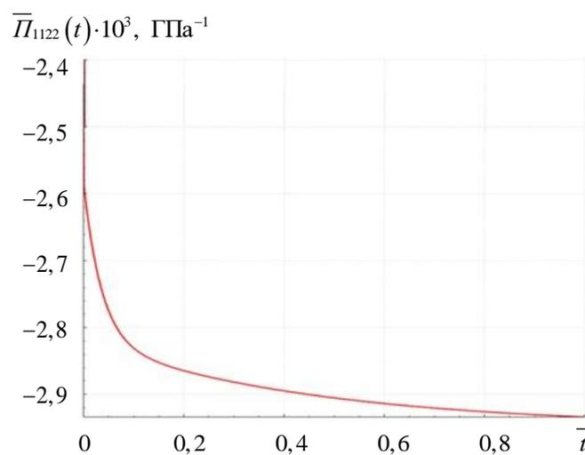
Рис. 13. Эффективная функция ползучести 1D композита  $\bar{P}_{1122}(t)$
