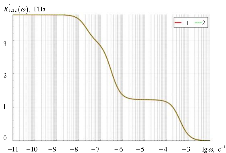
Рис. 10. Функции \bar{K}_{1212}(\omega) в полулогарифмических координатах для 1D композита: 1 — графики, построенные по формуле (35), 2 — аппроксимация помощью (38)
