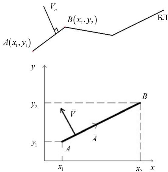
Рис. 1. Аппроксимация реальной кривой на местности линейным сплайном
