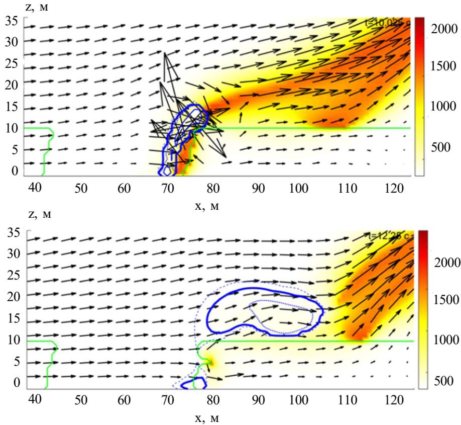
**Рис. 2.** Динамика тушения лесного пожара капсулами
