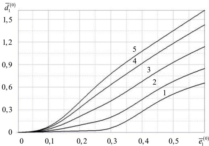
**Рис. 3.** Зависимость компоненты вектора индукции  $\bar{d}_1^{(0)}$  2-х слойного композита ВК4+ ВаТiО<sub>3</sub> от компоненты вектора средней напряженности электрического поля  $\bar{e}_1^{(0)}$  для различных значений концентрации фазы 1 (ВаТiО<sub>3</sub>):
