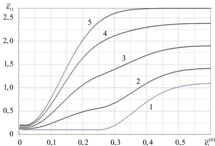
**Рис. 1.** Зависимость диэлектрической проницаемости  $\bar{\epsilon}_{11}$  2-х слойного композита ВК4+ ВаТiO<sub>3</sub> от компоненты вектора средней напряженности электрического поля  $\bar{\epsilon}_1^{(0)}$  для различных значений концентрации фазы  $h_1$  (ВаТiO<sub>3</sub>):
