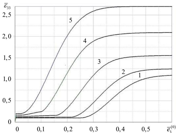
**Рис. 2.** Зависимость диэлектрической проницаемости  $\bar{\epsilon}_{33}$  2-х слойного композита ВК4+ ВаТiO<sub>3</sub> от компоненты вектора средней напряженности электрического поля  $\bar{\epsilon}_3^{(0)}$  для различных значений концентрации фазы 1 (ВаТiO<sub>3</sub>):
