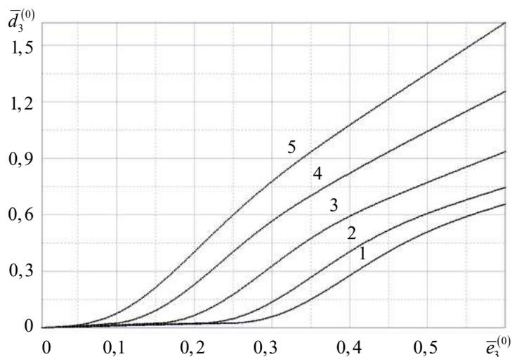
**Рис. 4.** Зависимость компоненты вектора индукции  $\bar{d}_3^{(0)}$  2-х слойного композита BK4+ BaTiO<sub>3</sub> от компоненты вектора средней напряженности электрического поля  $\bar{e}_3^{(0)}$  для различных значений концентрации фазы 1 (BaTiO<sub>3</sub>):
