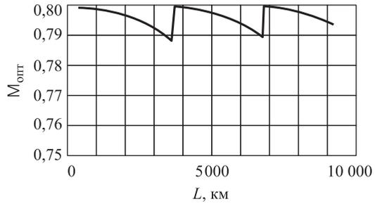
**Рис. 16.** Результат оптимизации  $M_{п}$  в крейсерском полете для стандарта температуры № 6 (полет проходит в одном эшелоне)
