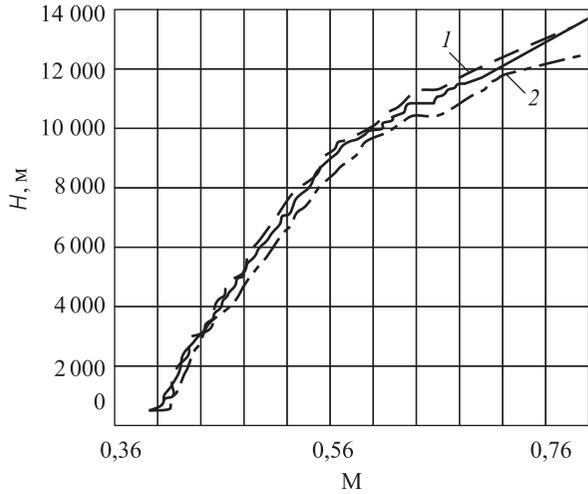
**Рис. 11.** Влияние давления на результаты оптимизации программы полета на крейсерском участке полета при МСА
