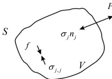
**Рис. 5.** Иллюстрация уравнений статической краевой задачи. В любой точке внутри \$V\$ и на \$S\$ внешние усилия уравновешены внутренними напряжениями, \$\sigma\_j\$ — вектор напряжения на площадке с нормалью \$x\_j\$
