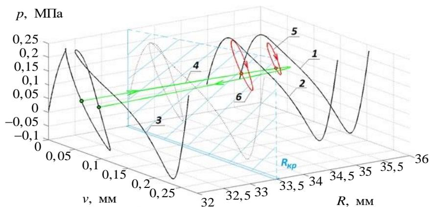
**Рис. 10** Сечения проекции поверхности равновесных состояний в пространстве: внешнее давление ( $p$ ), радиус кривизны ( $R$ ), прогиб в центре ( $v$ )
