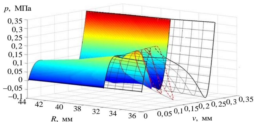
**Рис. 9.** Проекция поверхности равновесных состояний в пространстве: внешнее давление ( $p$ ); радиус кривизны ( $R$ ); прогиб в центре ( $v$ )
