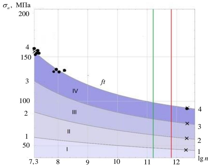
**Рис. 1.** Области развития дефектов I-IV, кривые усталости 1-1-3-3 и кривая усталости  $ft$  макроразрушения по дефектам четвертого уровня алюминиевого сплава ВД-17,  $\sigma_s = 260$  МПа,  $\sigma_{sp} = 400$  МПа
