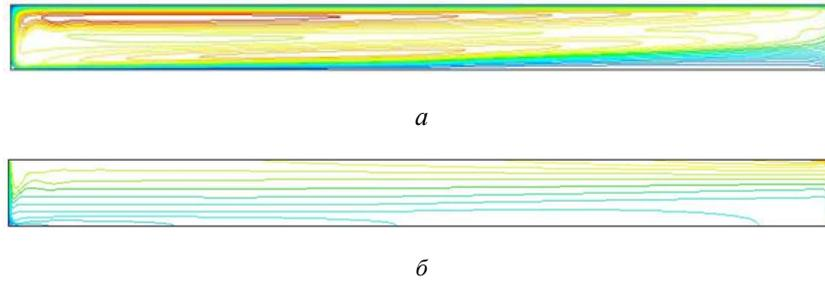
**Рис. 7.** Изолинии параметров в слое со свободной верхней границей ( $y = 1$ ) при  $Ra = 1,7 \cdot 10^7$ ,  $Pr = 0,1$ ,  $L/H = 12,71$ , ( $\partial T / \partial y|_{y=0, H=0} = 0$ ):
