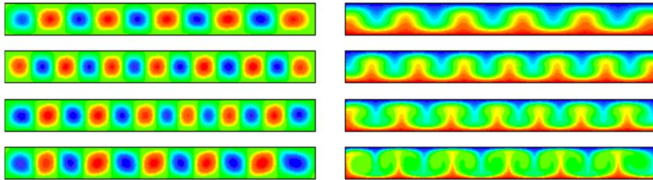
**Рис. 10.** Изолинии функции тока (слева) и изотермы (справа) для  $Ra = 3 \cdot 10^3$ ,  $5 \cdot 10^3$ ,  $10^4$ ,  $10^5$  (сверху вниз),  $Pr = 1$ ,  $L/H = 10$
