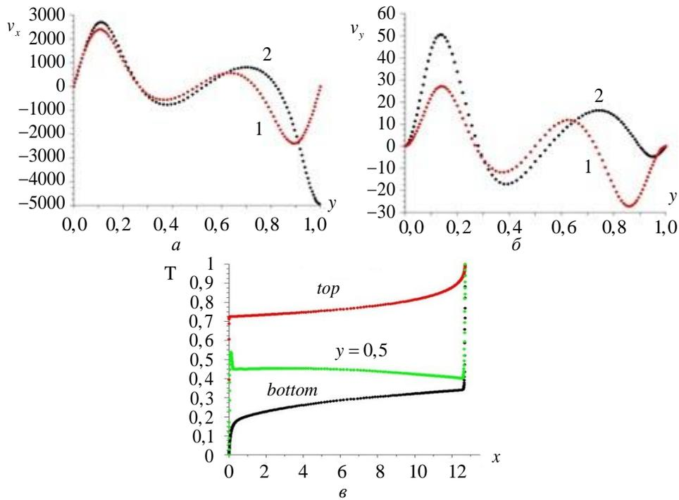
**Рис. 8.** Профили компонент скорости при  $Ra = 1,7 \cdot 10^7$ ,  $Pr = 0,1$ ,  $L/H = 12,71$ ,
