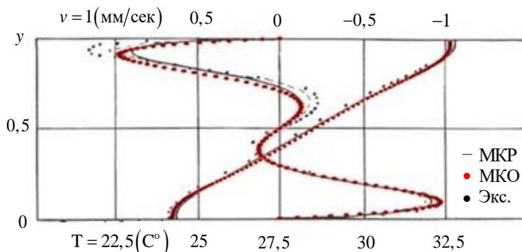
**Рис. 3.** Профили скорости и температуры в среднем вертикальном сечении, полученные методами МКР и МКО в сравнении с экспериментальными данными [9]:
