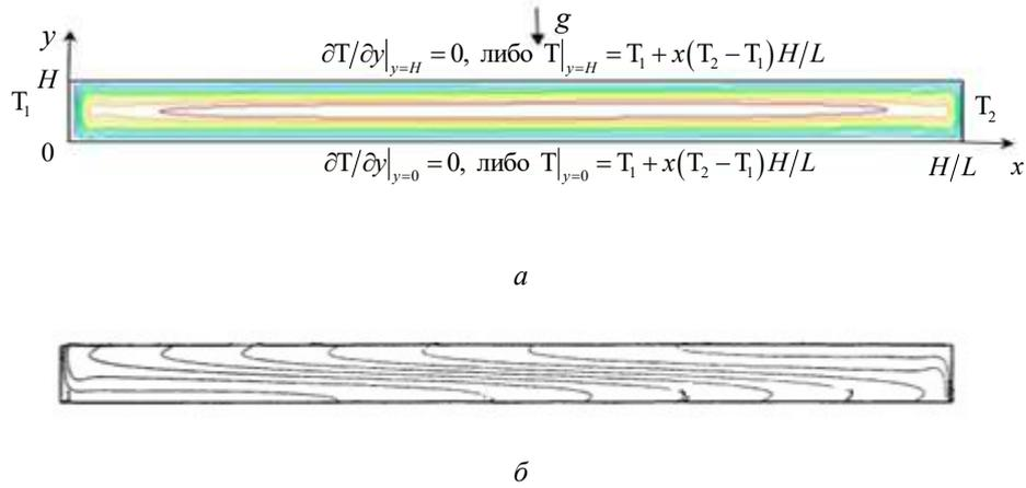
**Рис. 1.** Схема расчетной области, граничные условия и изолинии при  $Ra = 2 \cdot 10^5$ ,  $Pr = 5,8$ ,  $L/H = 12,71$ ,  $(\partial T / \partial y|_{y=0, H=0} = 0)$ :
