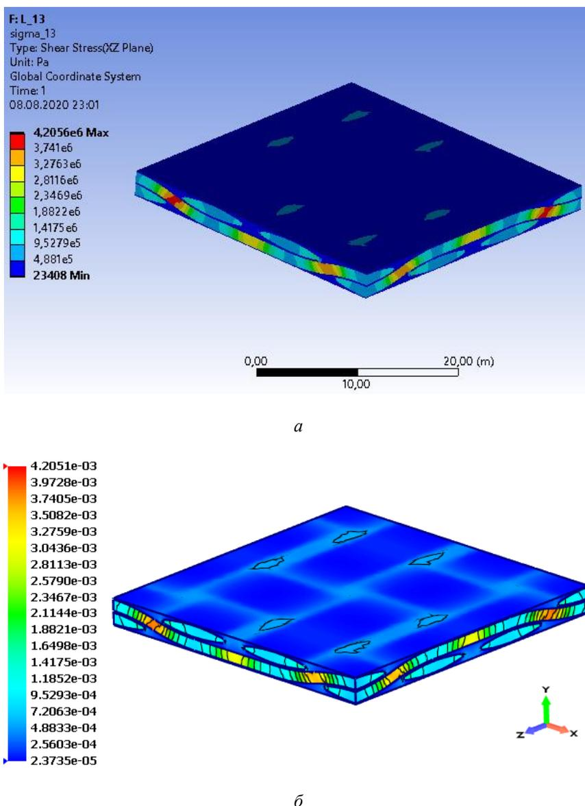
**Рис. 5.** Распределение напряжений  $\sigma_{13(13)}^\alpha$  в 1/8 ЯП, в задаче L<sub>13</sub> для тканевого ПКМ с саржевым переплетением:
