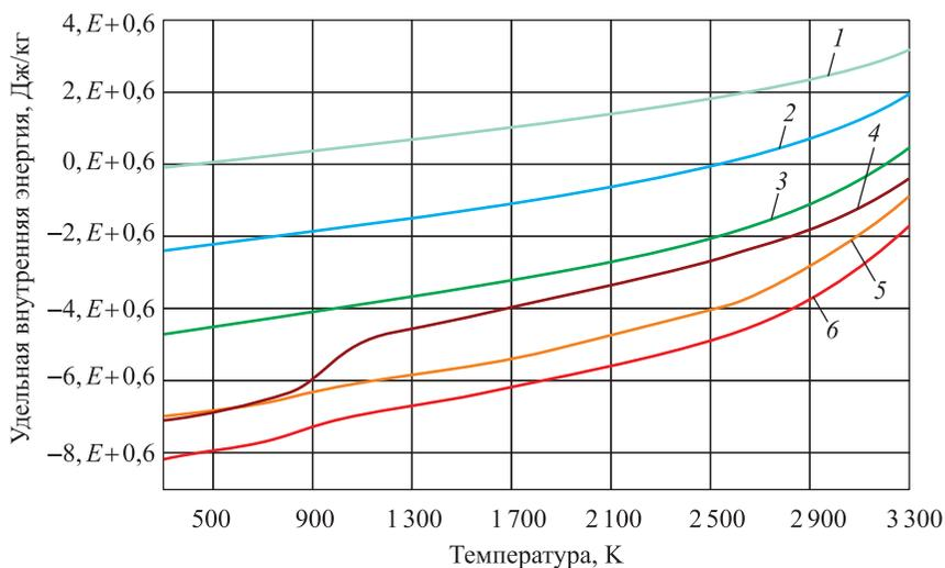
**Рис. 4.** Внутренняя энергия равновесной смеси продуктов сгорания ЭУ и кислорода, %:
