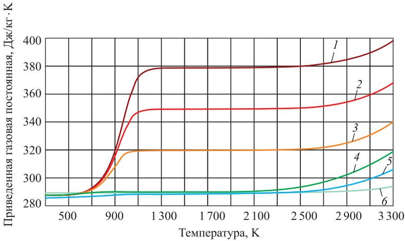
**Рис. 2.** Приведенная газовая постоянная равновесной смеси продуктов сгорания ЭУ и воздуха, %:
