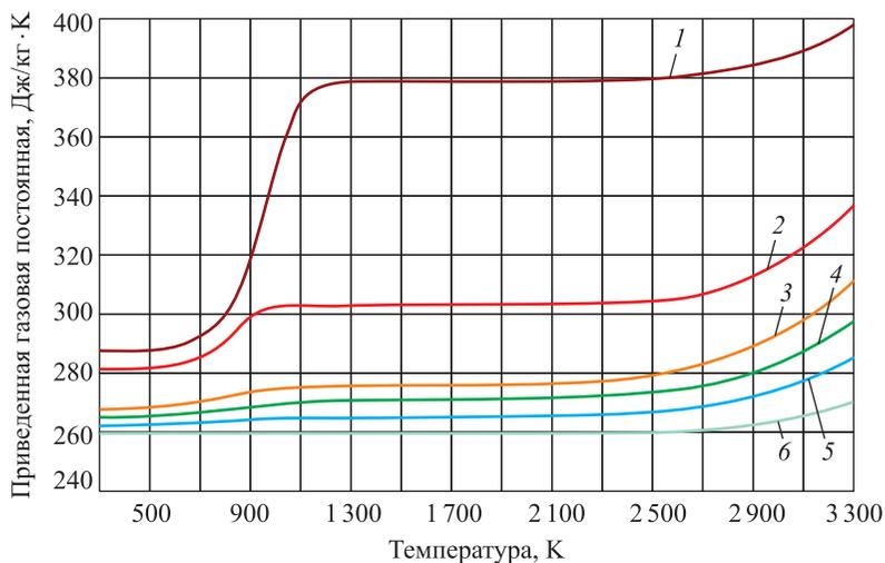
**Рис. 5.** Приведенная газовая постоянная равновесной смеси продуктов сгорания ЭУ и кислорода, %:
