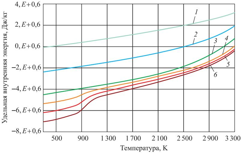
**Рис. 1.** Внутренняя энергия равновесной смеси продуктов сгорания ЭУ и воздуха, %:
