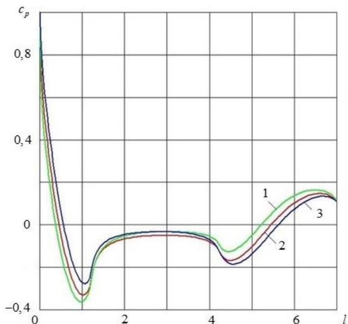
**Рис. 6.** Зависимость коэффициента давления  $c_p$  на поверхности эквивалентного тела от безразмерной продольной координаты  $l$ , отсчитываемой по оси эквивалентного тела, и угла  $\varepsilon$  при  $l_c = 3$ ,  $l_g = 1,25$ ,  $\alpha = 4^\circ$  и  $Re = 5 \cdot 10^6$  :
