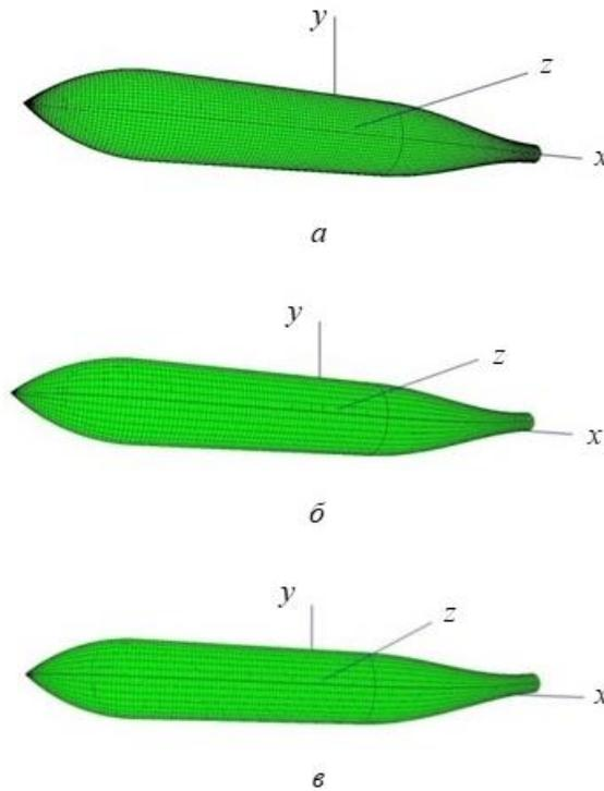
**Рис. 2.** Конфигурация эквивалентной поверхности при  $l_c = 3$ ,  $l_g = 1,25$  и  $Re = 5 \cdot 10^6$  для различных углов атаки:
