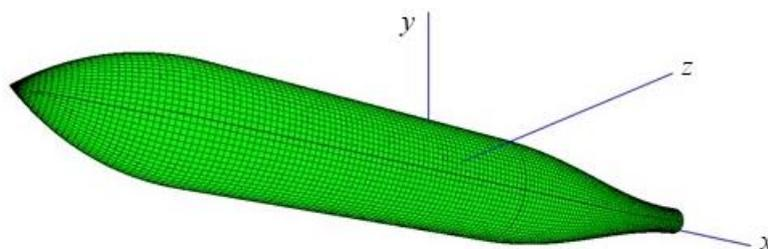
Рис. 3. Конфигурация эквивалентной поверхности при  $l_c = 3$ ,  $l_g = 1,25$ ,  $\alpha = 4^\circ$  и  $Re = 5 \cdot 10^6$
