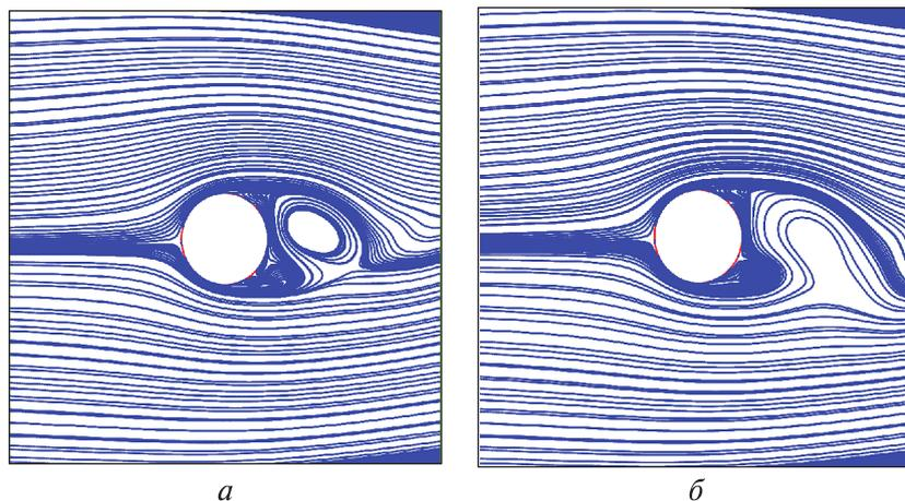
**Рис. 4.** Мгновенные линии тока для течения жидкости с периодом плавучести  $T_b = 6,28$  с, параметрами  $Re = 800$  и  $Fr = 1,28$ :
