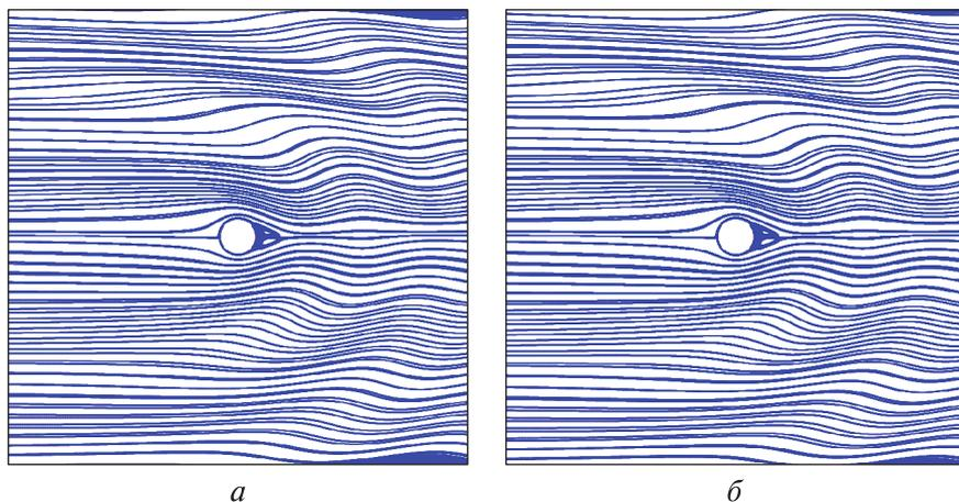
**Рис. 2.** Мгновенные линии тока для течения жидкости с периодом плавучести  $T_b = 6,28$  с и параметрами  $Re = 300$  и  $Fr = 0,48$ :
