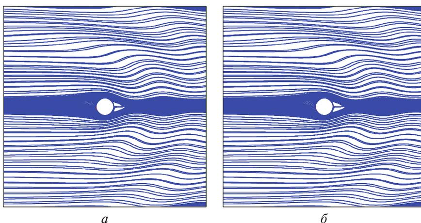
**Рис. 5.** Сравнение мгновенных линий тока для течения жидкости с периодом плавучести  $T_b = 6,28$  с, параметрами  $Re = 300$  и  $Fr = 0,48$ :
