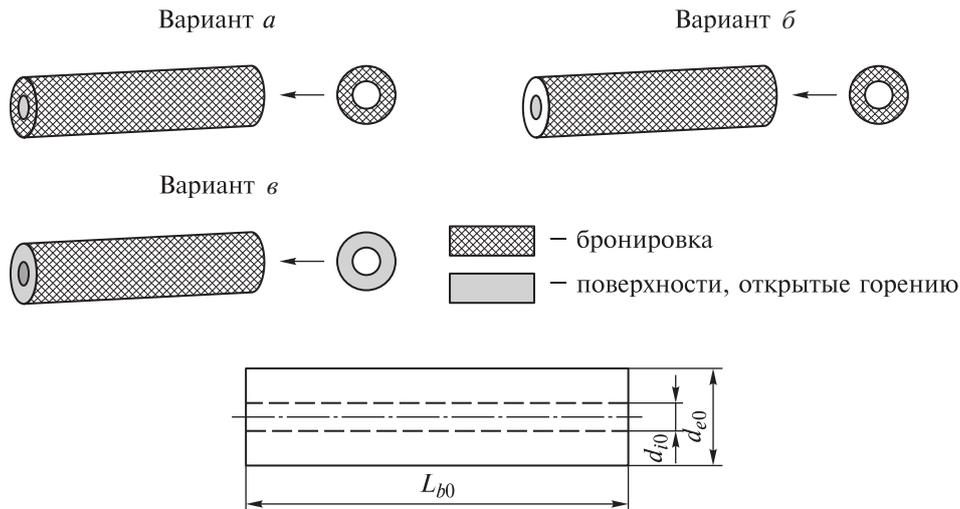
**Рис. 4.** Варианты трубчатых шашек многошашечного заряда ЭУ
