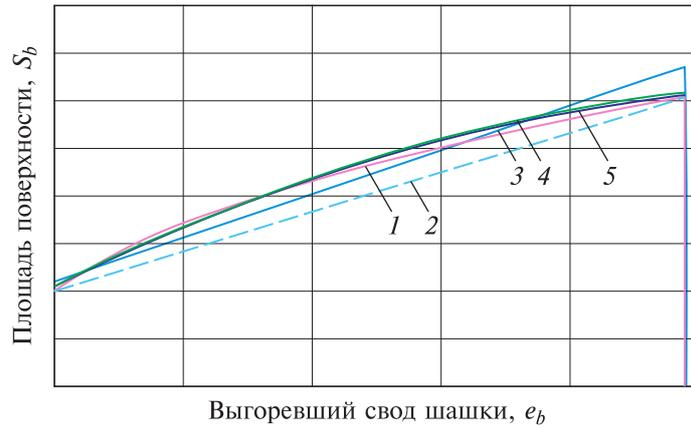
**Рис. 3.** Площадь поверхности горения как функция толщины выгоревшего свода:
