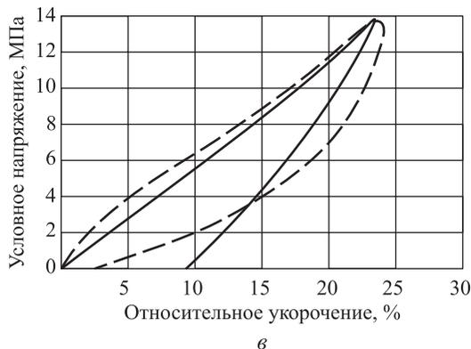
**Рис. 6 (окончание).** Сравнение расчетных и экспериментальных диаграмм сжатия полиуретана при различных скоростях нагружения:
