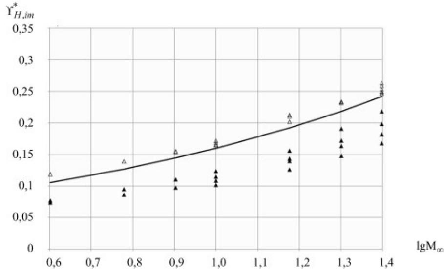
Рис. 1. Зависимость максимального значения критерия теплообмена от  $M_\infty$
