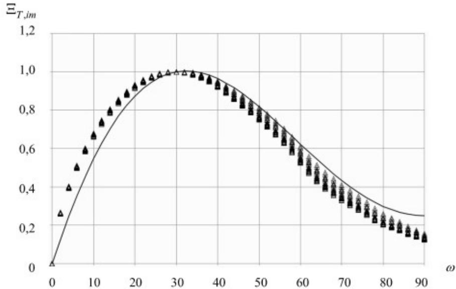
Рис. 2. Зависимость относительного числа Стантона от  $\omega$ , рад
