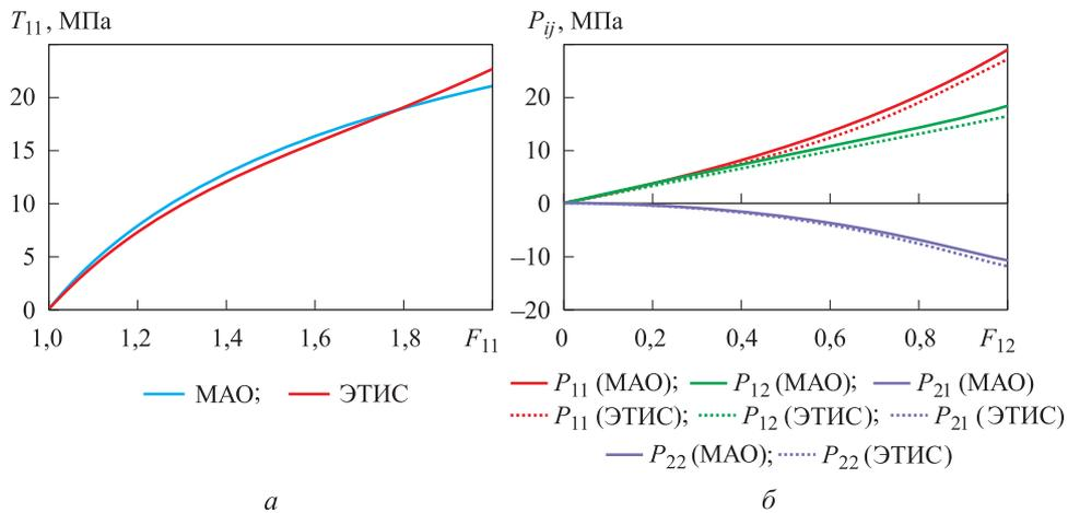
**Рис. 9.** Сравнительные диаграммы одноосного (а) и сдвигового (б) деформирования, полученных с помощью MAO и модели ЭТИС
