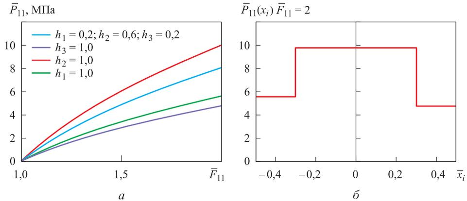
**Рис. 1.** Диаграммы деформирования  $\bar{P}_{11}(\bar{F}_{11})$  для слоистого композита, состоящего из трех слоев с разными толщинами слоев (а) и диаграмма распределения  $\bar{P}_{11}(\bar{F}_{11})$  в ЯП композита (б)
